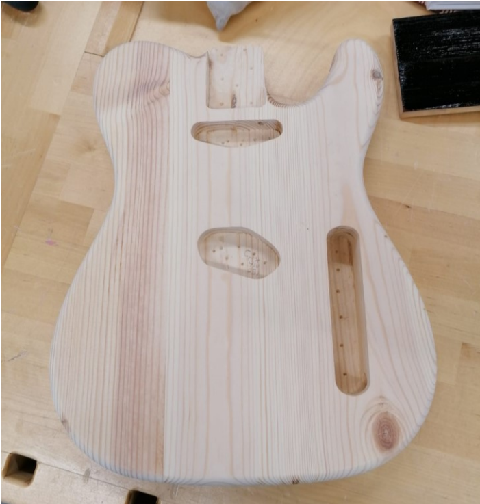
Kuva 3. Muotoonsa työstetty ja jyrstetty runkoaihio.
