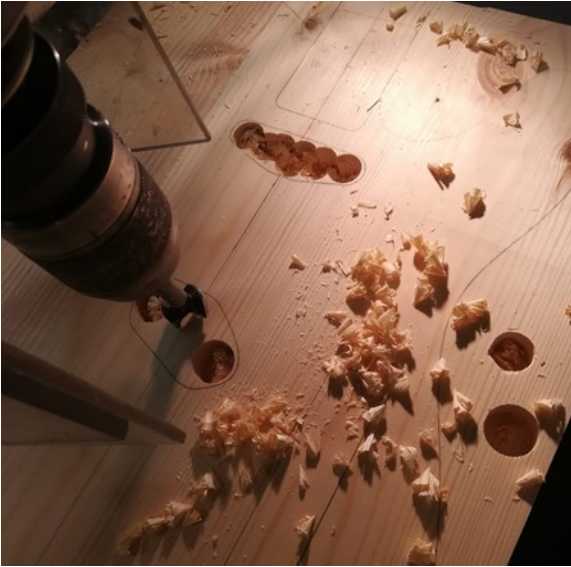
Kuva 2. Turhan puumateriaalin poistaminen ennen jysintää.
