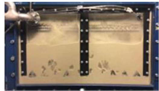
(d) 0.6 m/s, V_{sv} \sim 30\% , VD Mode 1B with Internal baffles, AD 198
