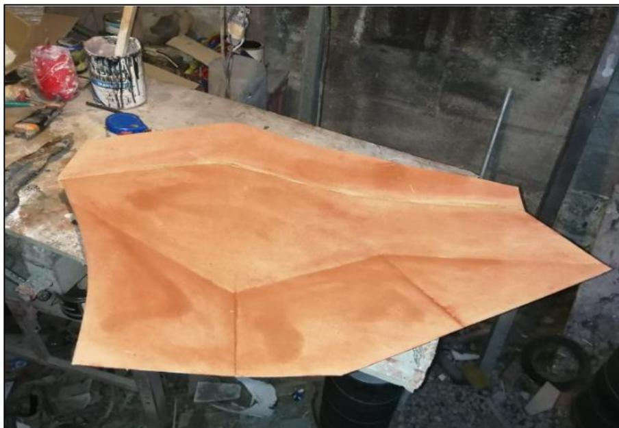
**Figura 3.38** Preparación del molde del carenado.
