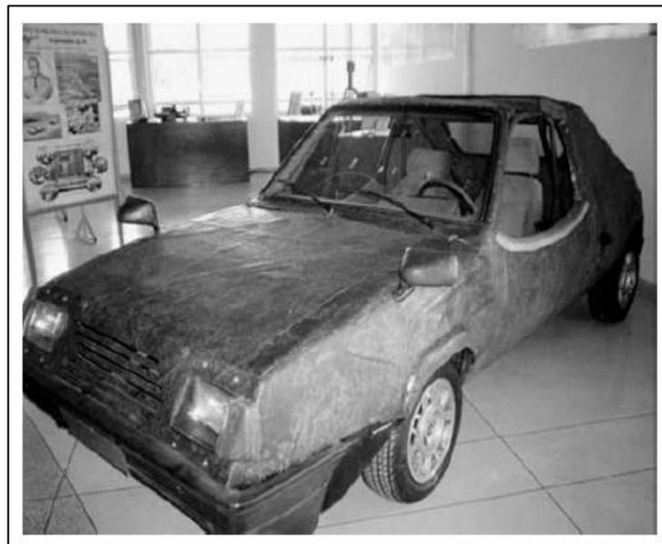
**Figura 1.8** Vehículo construido con fibra de yute
