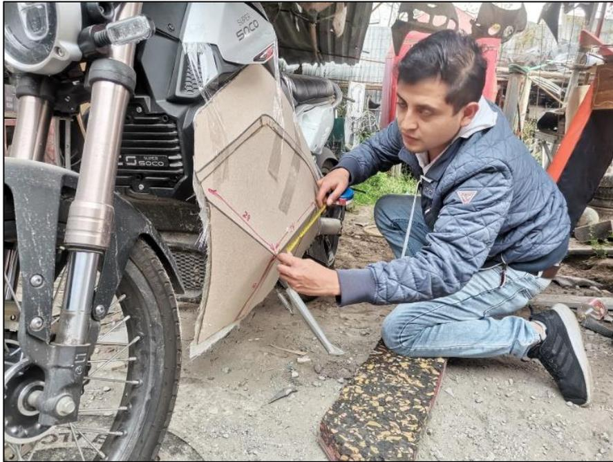
**Figura 3.34** Trazo del molde del carenado lateral.
