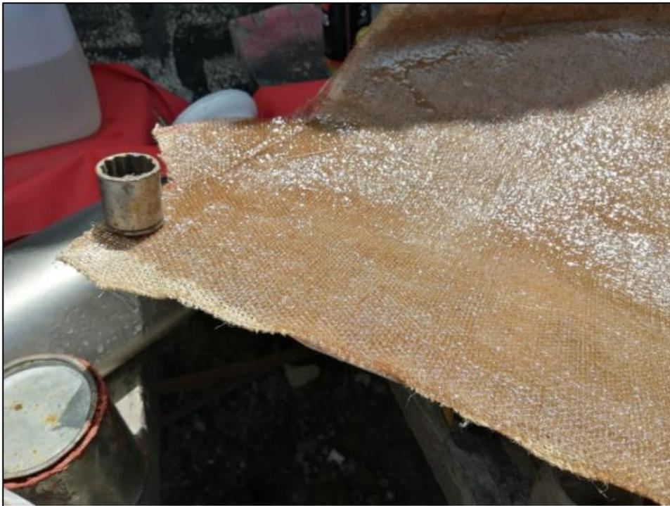
**Figura 3.39** Aplicación de las capas de resina epoxi y fibra de yute.
