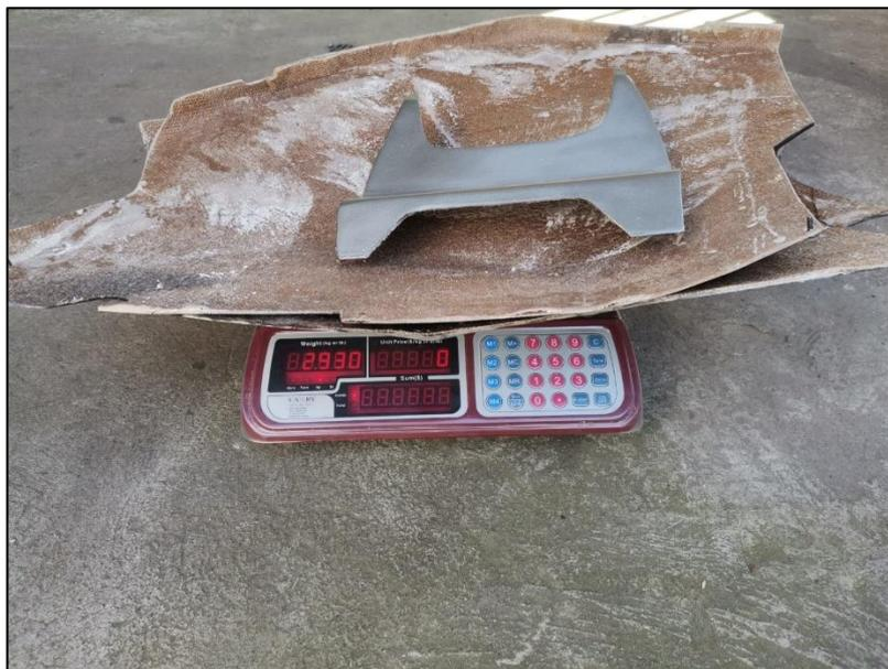
**Figura 3.44** Masa del Carenado Modificado – Modelo S
