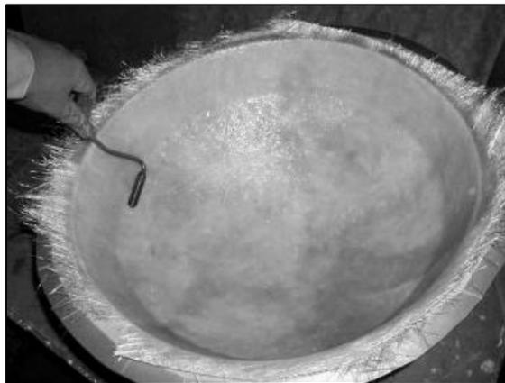
**Figura 2.25** Fabricación de un domo por estratificación manual
