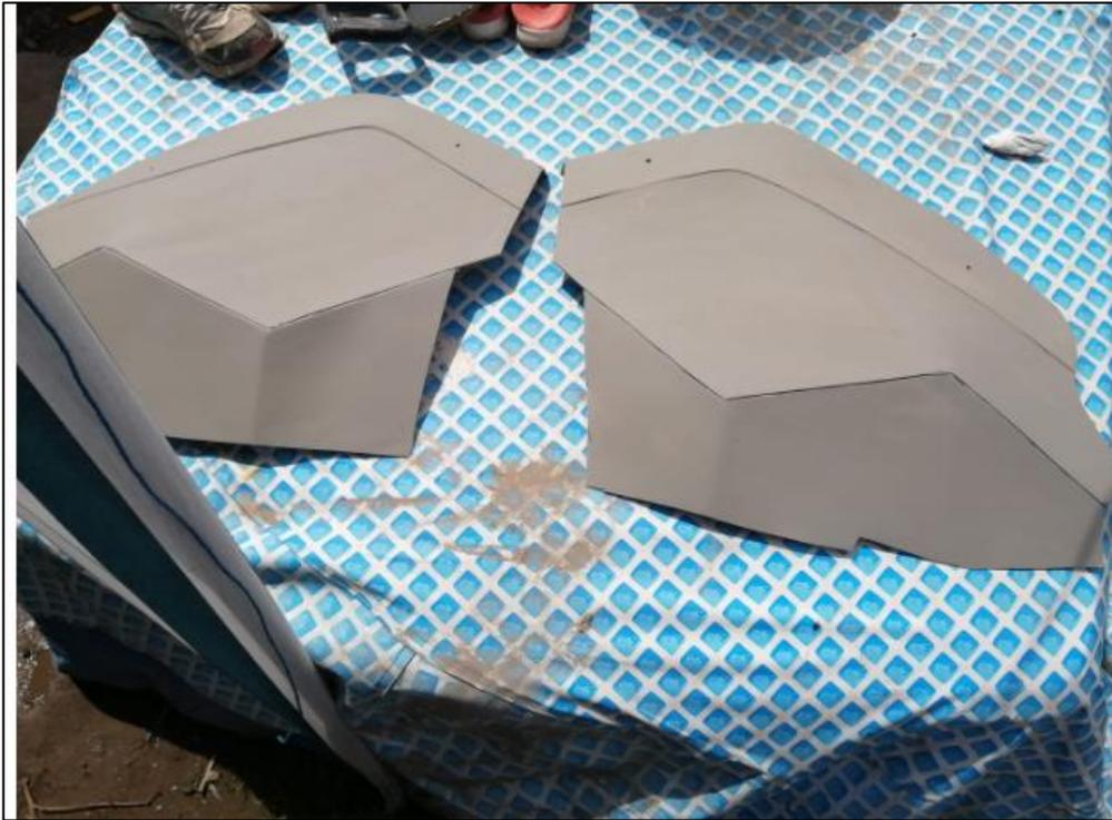
**Figura 3.40** Piezas del carenado lateral en fibra de yute con fondo de relleno.
