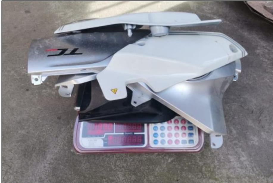
**Figura 3.43** Medida del peso del carenado original de la motocicleta
