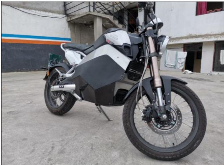
**Figura 3.42** Carenado modelo “S” finalizado e instalado en la motocicleta eléctrica.
