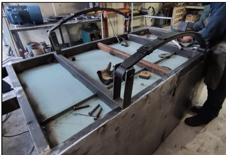
Figura 3. 17 Instalación de los paquetes de resortes en la estructura
