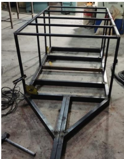
Figura 3.14 Fabricación estructura interna de la carrocería
