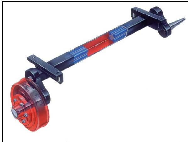
Figura 1.6 Barra de torsión (Ruedas RAR S.A., 2013)
