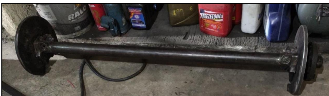
Figura 3. 18 Punta de ejes para Rin 14”
