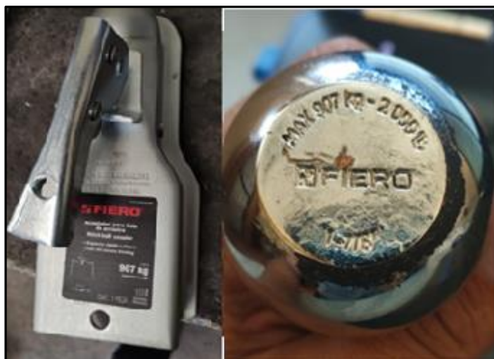
Figura 3. 22 Acople y bola de enganche 2000lb
