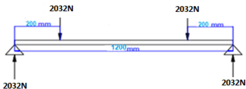
Figura 2. 21 Cargas que soporta el eje
