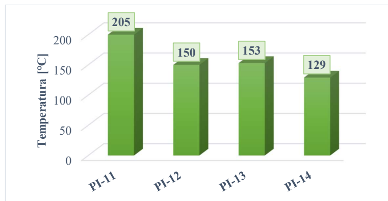
Rysunek 60. Temperatury zeszklenia azopoliiimidów funkcjonalizowanych w łańcuchu bocznym (PI-11 – PI-14) odczytane z drugiego cyklu ogrzewania. Wartości T_g PI-11 i PI-12 pochodzą z pracy [71], natomiast PI-13 i PI-14 z publikacji [72]
