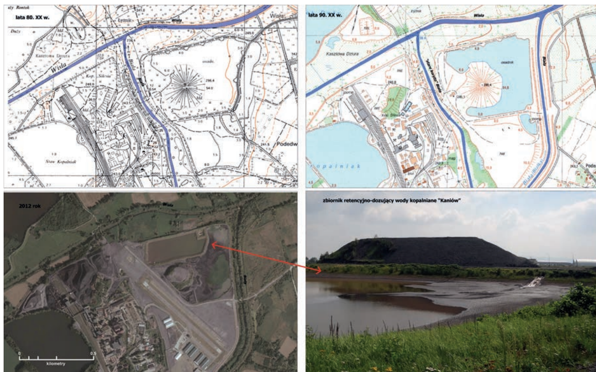
Fot. 6. Zmiany położenia ujściowego odcinka rzeki Białej na terenie Przedsiębiorstwa Górniczego „Silesia” oraz zbiornik retencyjno–dozujący wody kopalniane „Kaniów”
