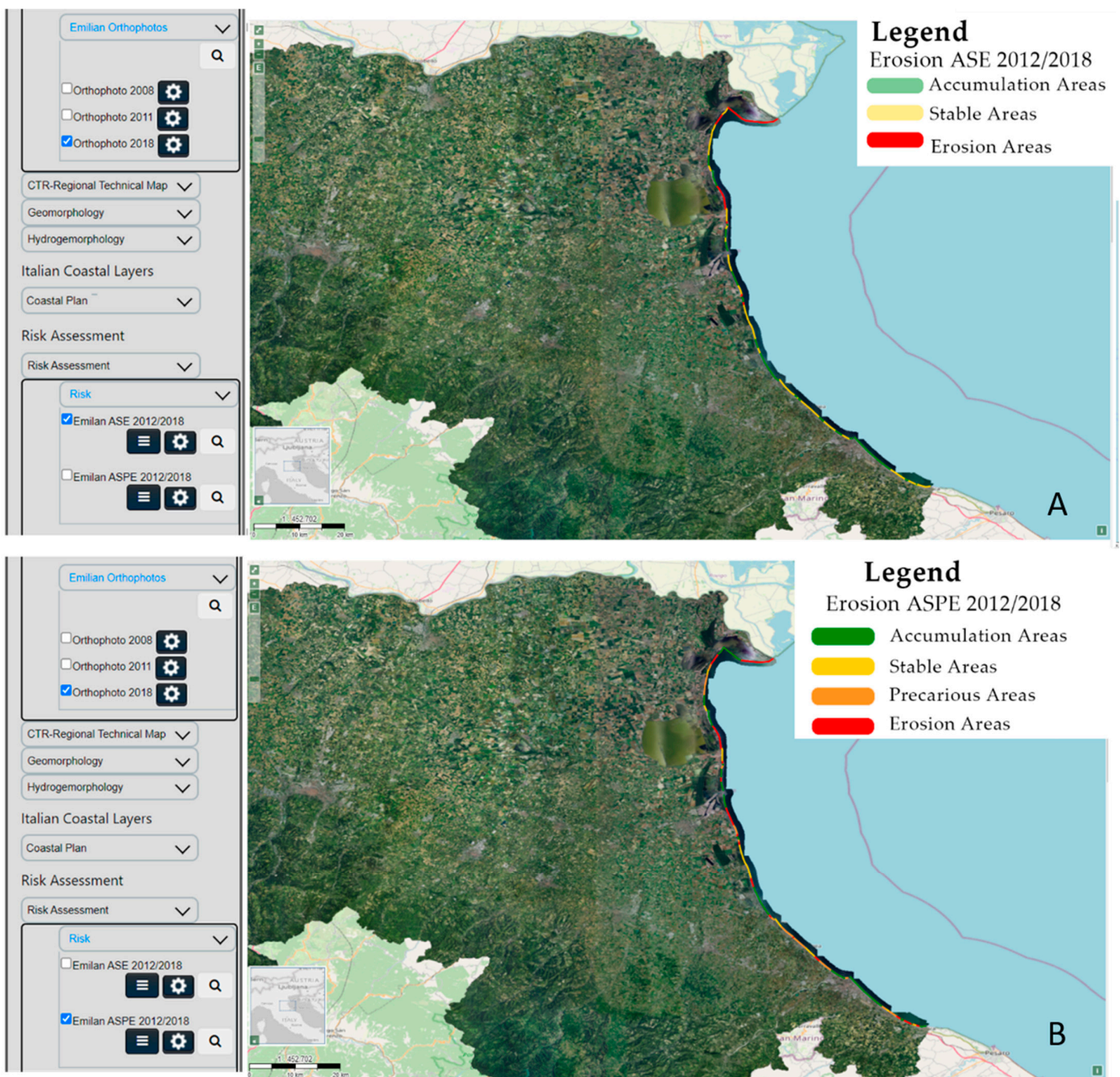
Figure 14. Erosion indicators for Emilia Romagna: ASE (2012/2018) (A); ASPE (2012/2018) (B).
