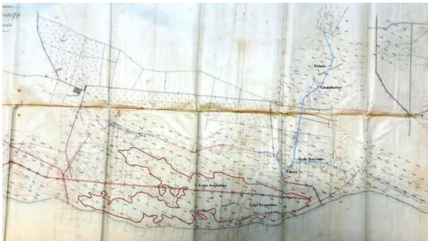
Figura 5 - Cartografia allegata al progetto dell'Ing. L. Libertini. Si noti come originariamente il fiume Giammatteo dovesse sia defluire verso il lago di Acquatina che aggirarlo attraverso un canale che terminava a mare poco a nord del bacino stesso.
