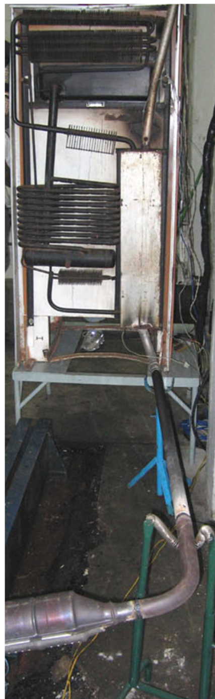
Fig. 19: Accoppiamento del sistema di scarico del motore endotermico alla pompa termica del DAR nello studio condotto da Manzela et al. [26]
