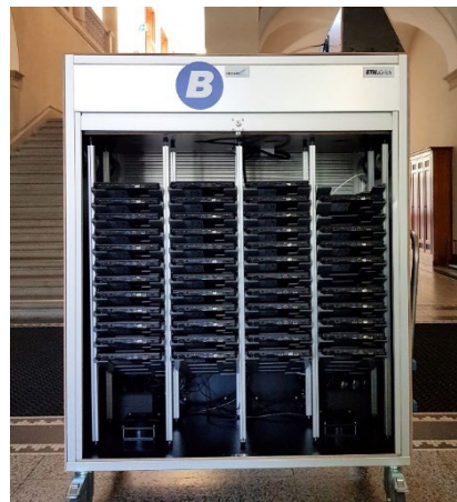
Abbildung 9: Gerätewagen für Lagerung, Transport & Remote-Management mobiler Prüfungslaptops.
