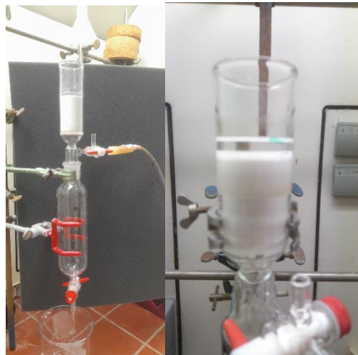
Abbildung 25: links: Aufbau der DCVC-Apparatur: Fritte, Dreiwegehahn mit Abgang zur Pumpe und Vorratsgefäß mit Hahn; rechts: Lösungsmittelbande nach dem korrekten Packen der Säule.
