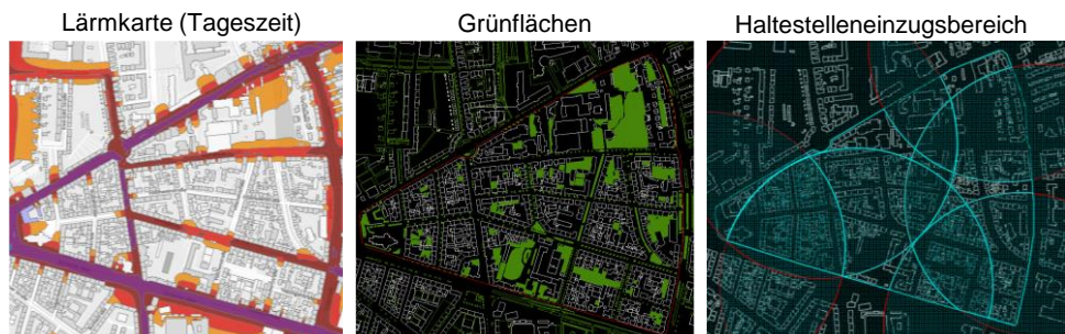
Abbildung 5.2: GIS-Analyse in Auto CAD (eigene Darstellung, basierend auf eigenen Berechnungen und Daten aus den Katasterkarten und des Mobilitätsportals der Stadt Karlsruhe (Stadt Karlsruhe) sowie privaten Anbietern (KVV, 2020a, KVV, 2020b; Stadtmobil Karlsruhe)
