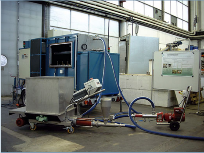
◀ Abb. 3: Mobile Pilotanlage am Institut für Hochleistungsimpuls- und Mikrowellentechnik (IHM) des KIT: Im blauen Anhängeraufbau befindet sich der Impulsgenerator, der durch den geöffneten Wartungszugang unten ansatzweise zu sehen ist. Im Vordergrund steht der Vorlagentank mit bodenseitig integrierter Speisepumpe. Damit wird die Mikroalgen-suspension in die Behandlungszelle innerhalb der Impulsanlage gefördert und dort kontinuierlich mit Hochspannungsimpulsen beaufschlagt. Mit der ausgangsseitigen Pumpe, rechts im Bild, wird die Mikroalgen-suspension auf einem Arbeitsdruck von 2–3 bar gehalten, um ungewollten Plasmaentladungen im Inneren der Behandlungszelle entgegenzuwirken.
