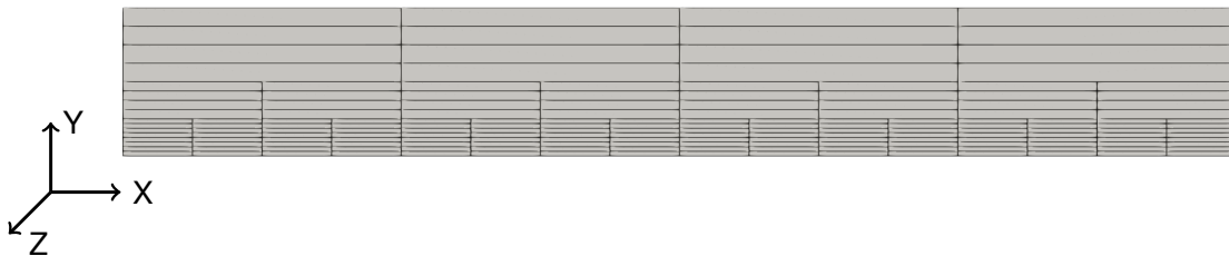
Abbildung 7.10.: Das zweimal adaptiv verfeinerte und in der X-Richtung halbierte Gitter für den Fall der Bodenkühlung.
