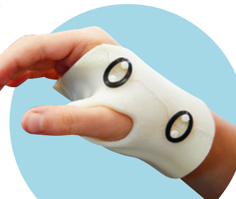
HANDORTHESE ALS BEISPIEL EINES FASERVERSTÄRKTEN INDIVIDUALBAUTEILS AUS DEM FREEFORMER 300-4X
