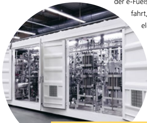
INDUSTRIELLE PILOTANLAGE VON INERATEC ZUR HERSTELLUNG VON E-FUELS
