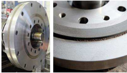
Abbildung 7.2: Gegenreibrscheibe (links) und Reibbelag A auf Belagträger (rechts)
