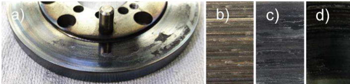
Abbildung 8.4: Beispiele für Materialübertrag vom Reibbelag hin zur Gegenreibeischeibe: Gusscheibe der Kupplung mit Fetzen des Reibbelags (a), Materialübertrag von Kupfer bei Friktionspaarung B (b) sowie Materialübertrag und dessen Oxidation bei Friktionspaarung D (c) und E (d) (Albers, Klotz, Fink & Ott, 2021)
