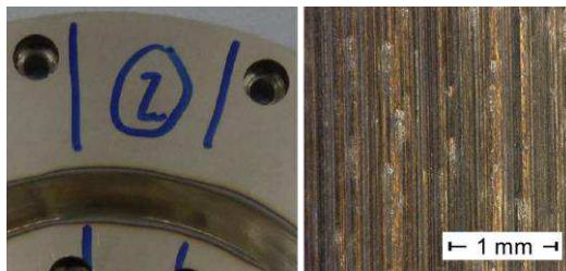
Abbildung 7.21: Materialübertrag auf der Gegenreibrscheibe bei S 1 und EK 3
