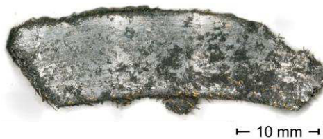
Abbildung 7.30: Ausbruch in Laststufe 1.5
