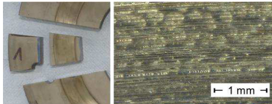
Abbildung 7.76: Materialübertrag von Kupfer auf die Flanschscheibe: Zu sehen in Fotos (links) und mikroskopischen Aufnahmen (rechts)
