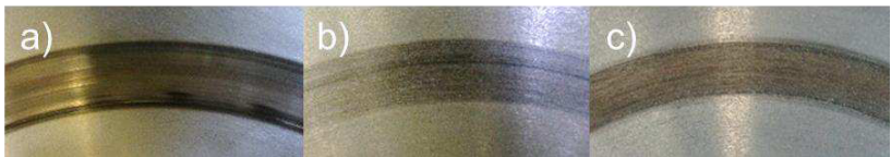
Abbildung 7.55: Fotoaufnahmen der 12 mm breiten Gegenreibeischeiben nach (a) dem Einlauf mit C45, (b) dem Einlauf mit GGG40 und (c) dem optimierten Einlauf mit GGG40
