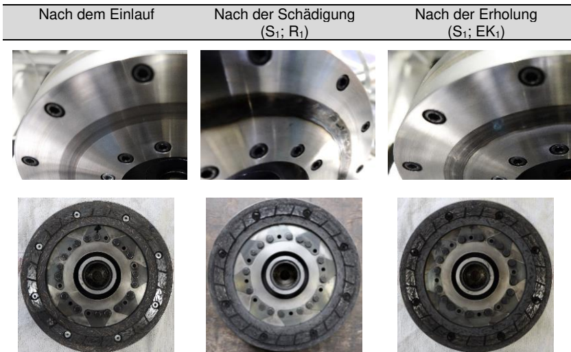
Abbildung 7.42: Fotoaufnahmen nach dem Einlauf, der Schädigung und der Erholung
