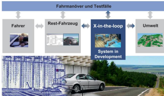
Abbildung 2.14: IPEK-X-in-the-Loop-Ansatz (Albers, Behrendt, Klingler & Matros, 2016) auf Basis von (Düser, 2010)
