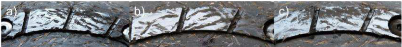
Abbildung 7.54: Fotoaufnahmen der gewickelten 12 mm breiten Reibbeläge nach (a) dem Einlauf mit C45, (b) dem Einlauf mit GGG40 und (c) dem optimierten Einlauf mit GGG40
