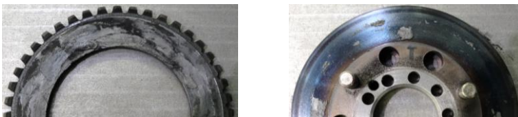
Abbildung 7.87: Adhäsiver Verschleiß bei Reibbelag A, Ringbreite 18,5 mm
