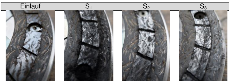
Abbildung 7.41: Nach dem Einlauf und jeweils direkt nach der Schädigung
