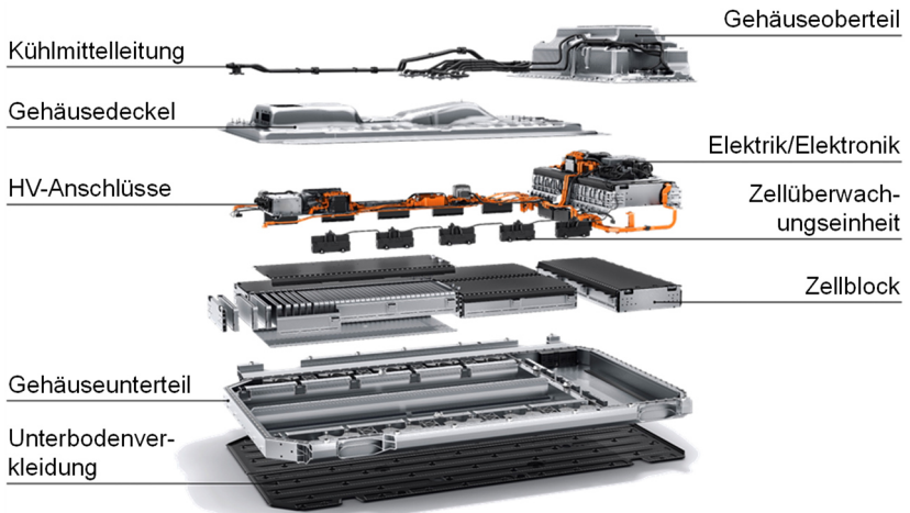
Abbildung 2.33: Explosionsdarstellung einer HV-TB (Beschriftung angepasst, Bild von Daimler AG, 2018)
