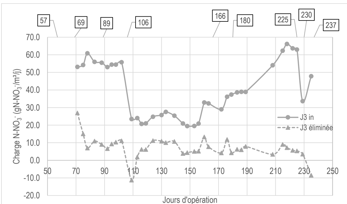
Figure 38 - Charges appliquées et éliminées en N-NO_3^- en fonction des jours d'opération pour le réacteur J3 (jours 0 à 240)
