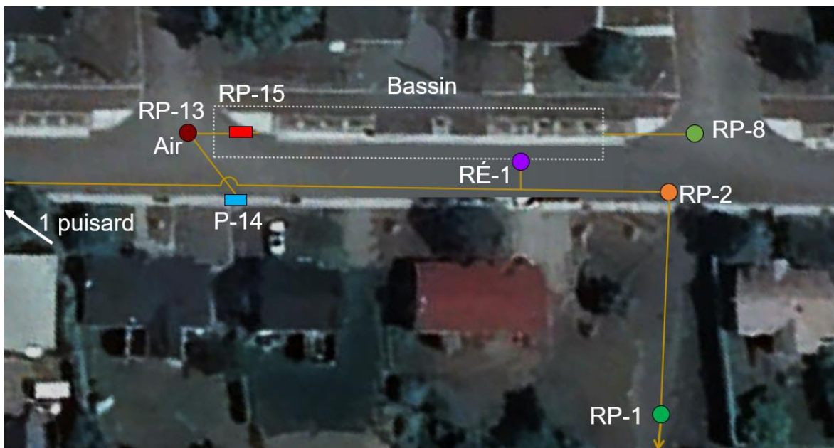
Figure 22: Localisation des capteurs de pression et du débitmètre selon le nom du regard où puisard dans lequel ils sont situés
