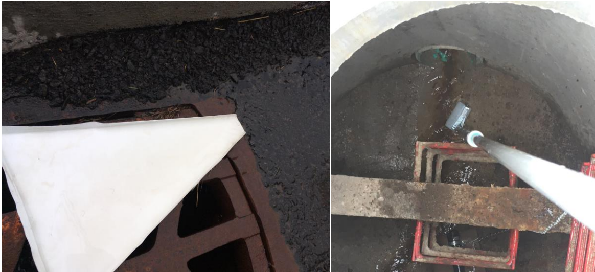
Figure 14: Équipements d'échantillonnage de l'eau de ruissellement et de la sortie du bassin
