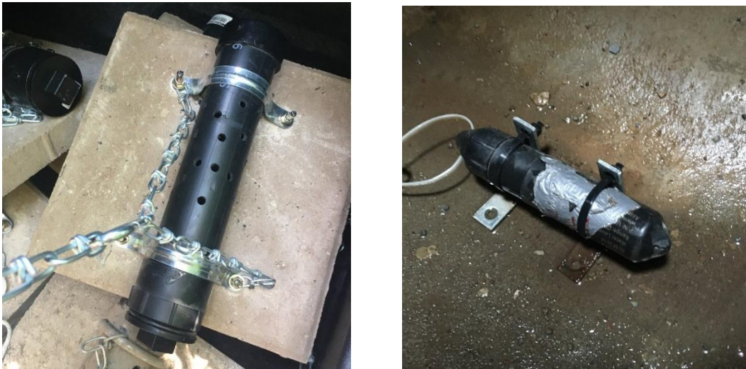
Figure 9: Installation des capteurs de pression lorsqu'immergés en tout temps (à gauche) ou non (à droite)
