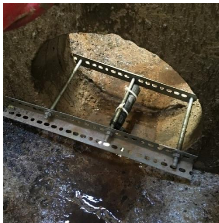
Figure 10: Positionnement du capteur de pression dans RE-1
