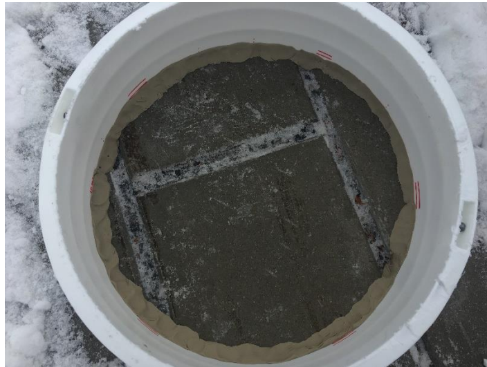
Figure 12: Montage utilisé pour les tests d'infiltration
