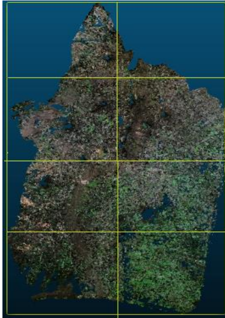
Figure 102: Le nuage de points divisé en octree.
