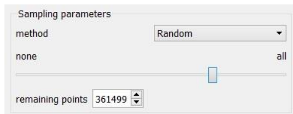
Figure 101: La méthode « aléatoire » de sous-échantillonnage [99].
