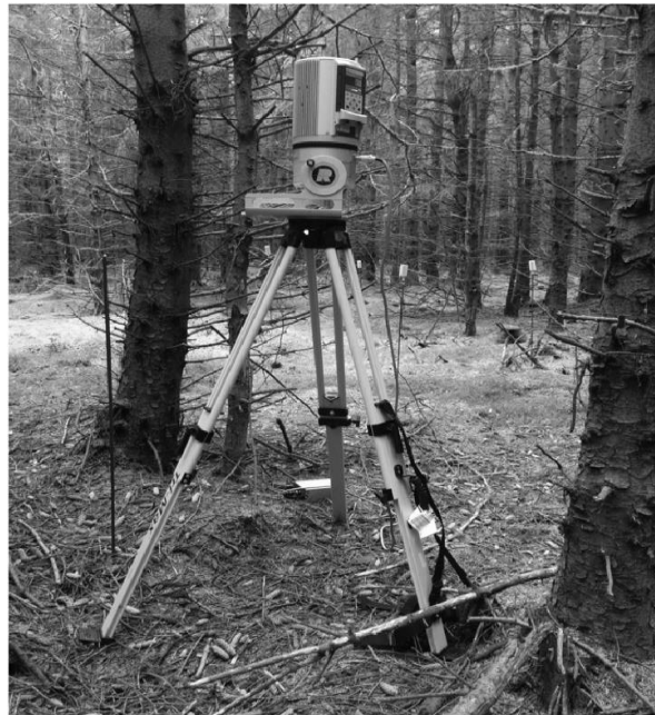
Figure 10: Utilisation un station LiDAR terrestre (Riegl-VZ 400) totale pour scanner et analyser de données des zones naturelle 9 .
