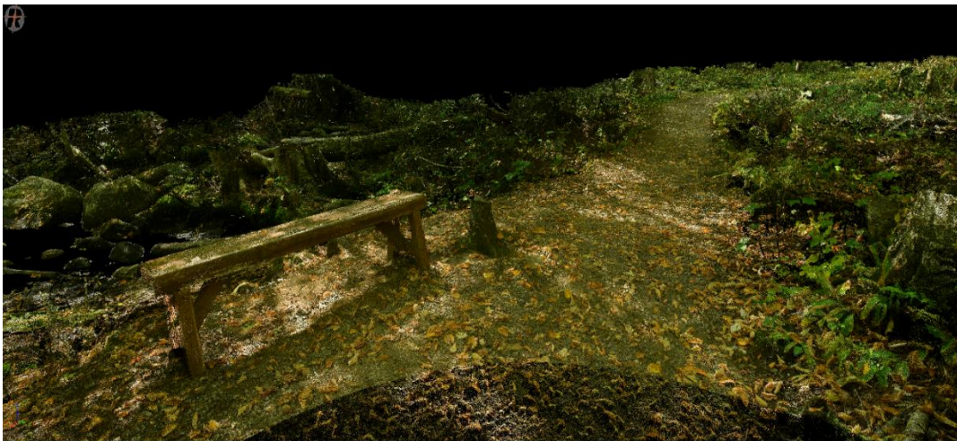
Figure 34: Scène 3D après application des outils de filtre de hauteur et de filtre de terrain.
