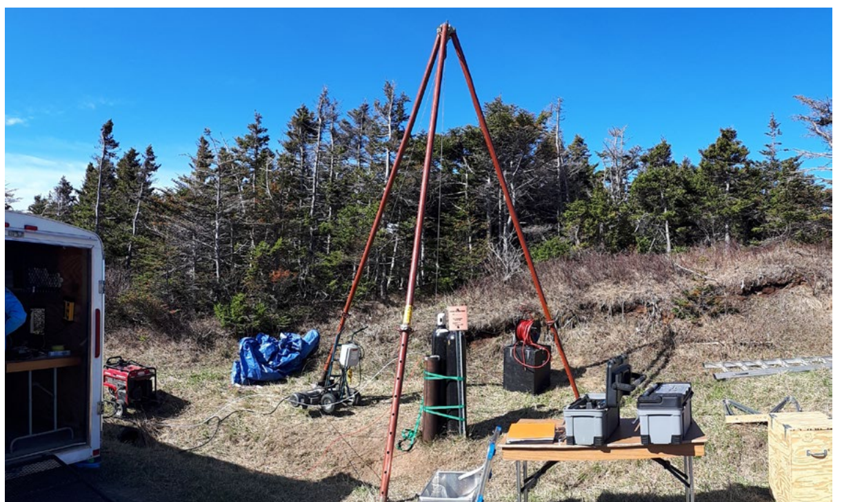
Travaux d'estimation de la perméabilité d'un puits à l'aide d'un système d'obturateurs pneumatiques, île de la Grande Entrée.
