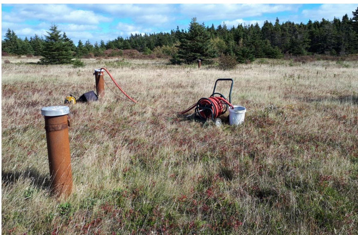
Échantillonnage d'un puits à l'aide d'une pompe submersible, île du Cap aux Meules.
