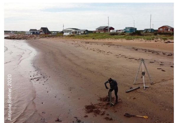
Forage manuel de mini-piézomètres servant à estimer les résurgences sur la plage de la Martinique, île du Cap aux Meules.
