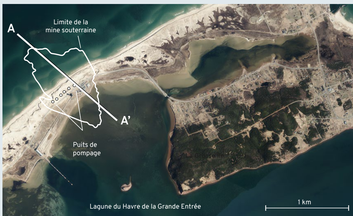
Localisation de Mines Seleine près de la Grosse Île indiquant les limites de la mine souterraine et la position des puits de pompage. Modifié de Mines Seleine (2013).
