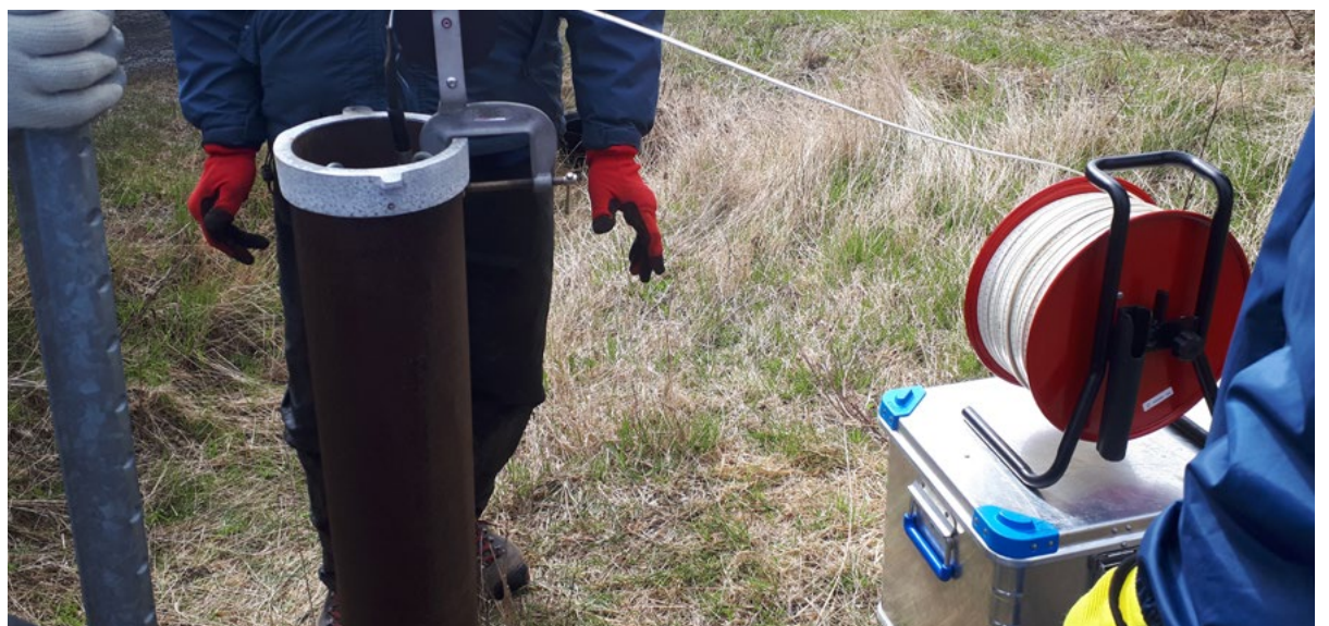
Prise d'une mesure ponctuelle d'un niveau d'eau dans un puits à l'aide d'une sonde avec ruban gradué, île de la Grande Entrée.
