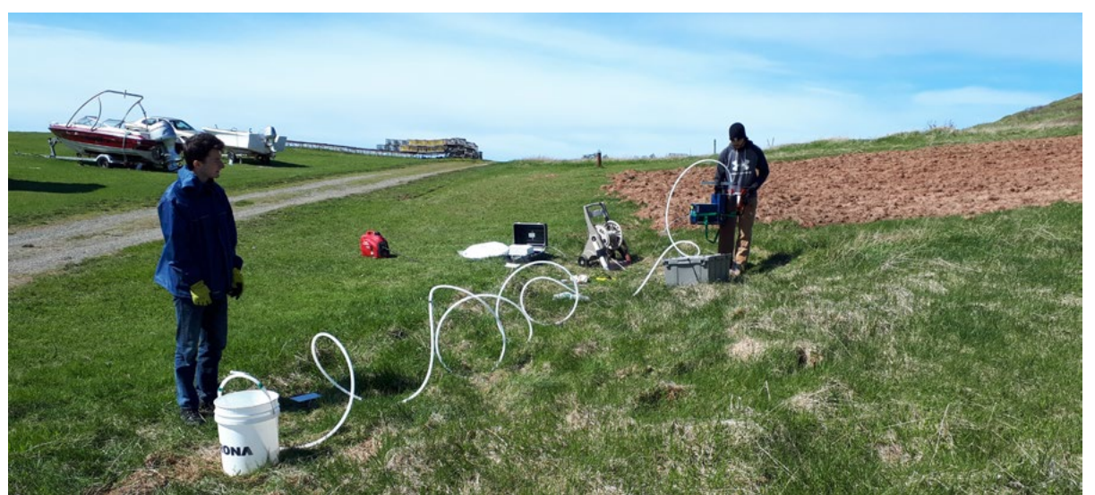
Pompage pour l'échantillonnage dans un puits abandonné, Grosse île.
