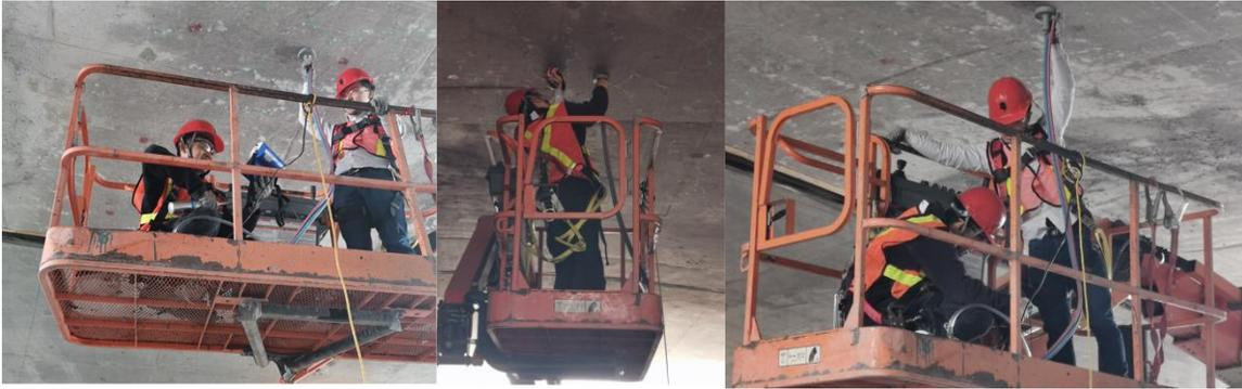
Figure 100. Réalisation des tests Torrent in situ sur la structure à l'étude
