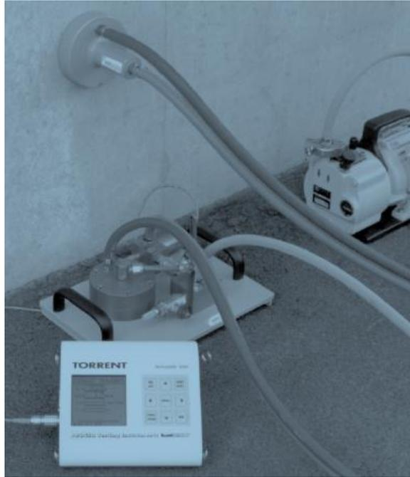
Figure 98. Matériel Torrent Proceq SA (Torrent, 1997)
