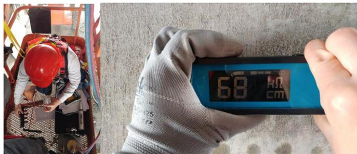
Figure 97. Réalisation des tests Wenner in situ sur la structure à l'étude
