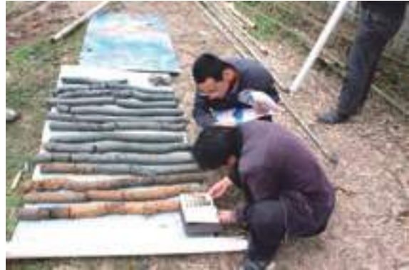
図9 ボーリング芯の分層、土色帳を使用しての土色記録
