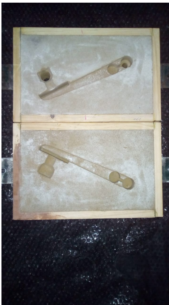
Figura 16 – Caixa de fundição moldada com auxílio dos modelos
