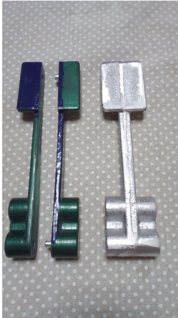
Figura 17 – Modelo e Peça fundida em escala
