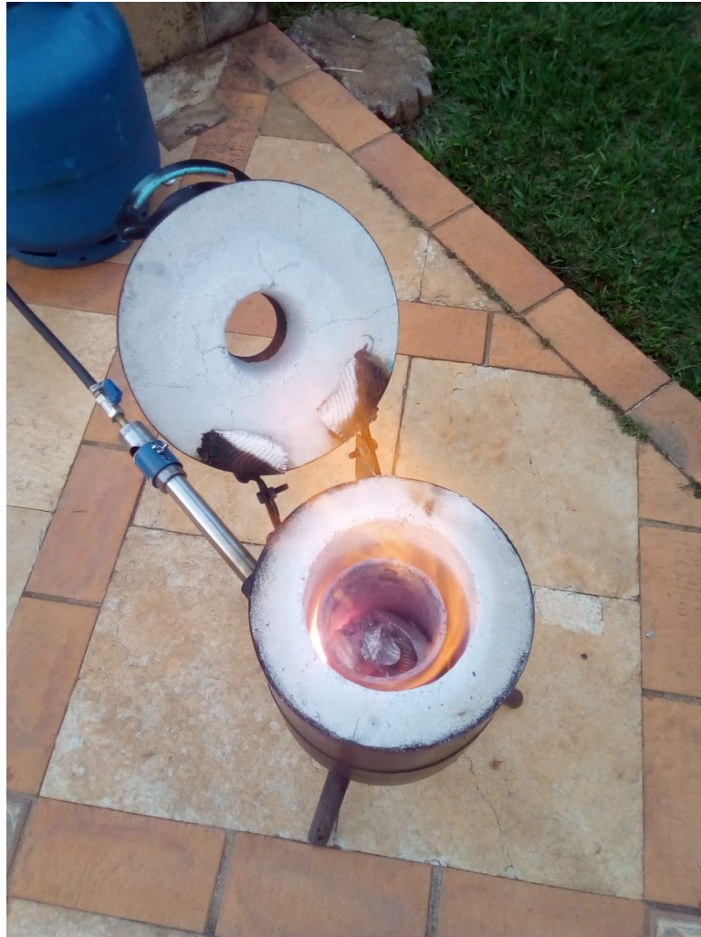
Figura 20 – Cadinho com alumínio fundido
