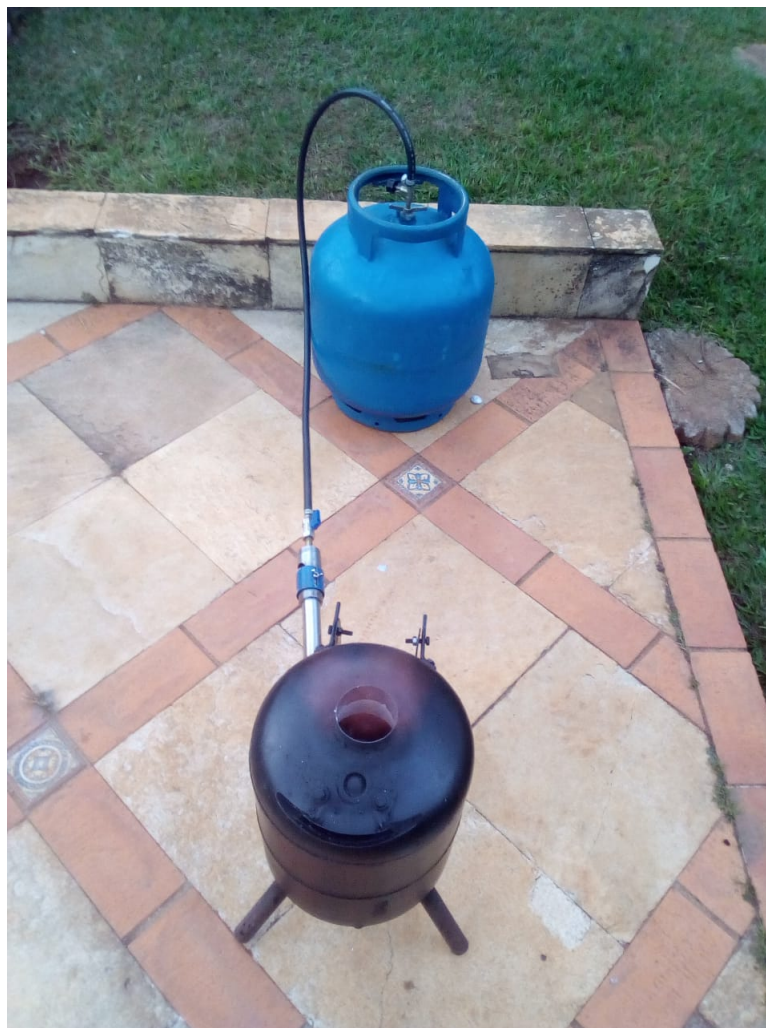
Figura 18 – Forno de fundição alimentado a gás GLP
