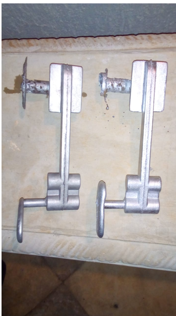
Figura 25 – Pedais fundidos em alumínio
