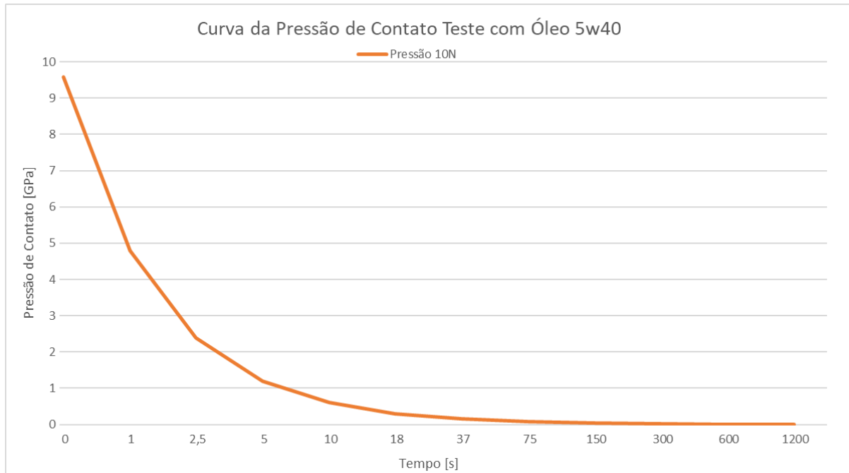
Figura 35 - Curva da Pressão de contato para o ensaio lubrificado com óleo 5w40 e carga 10N
