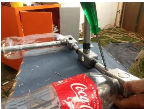
Fixação das juntas estruturais das esculturas.
