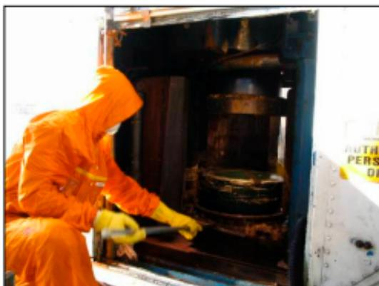
Figura 24 – Tambor prensado pela técnica de supercompactação. Fonte: (SANTOS; LIMA, 2007)
