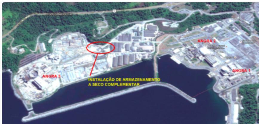
Figura 32 – Local onde ficará situada a UAS no complexo da CNAAA. Fonte: (ELETRO-NUCLEAR, 2020).
