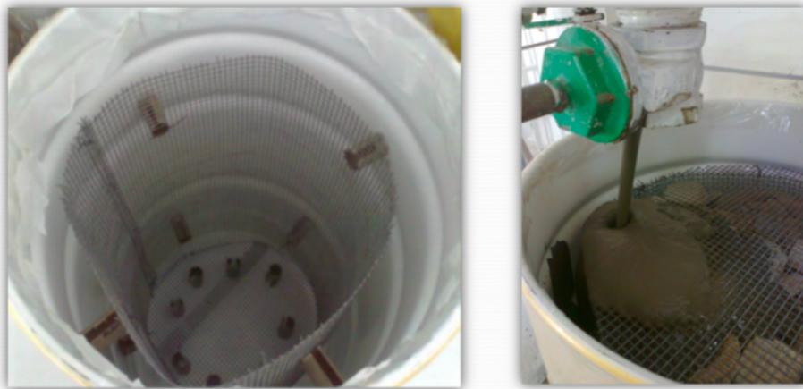
Figura 26 – Imobilização de rejeitos radioativos em cimento. Fonte: (COTA, 2014).
