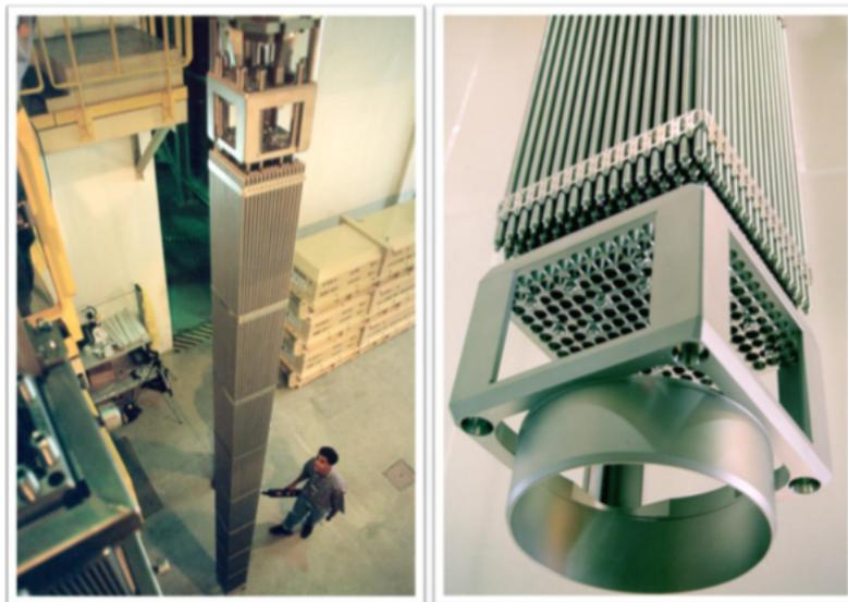
Figura 4 – A esquerda elemento combustível em escala real, e a direita partes do elemento, Fonte: (COSTA, 2018).
