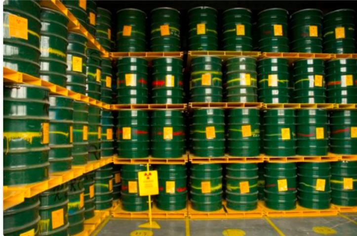
Figura 29 – Depósito Intermediário para acometimento de resíduo nuclear na Central Nuclear Almirante Álvaro Alberto. Fonte: (ELETRONUCLEAR, 2020).
