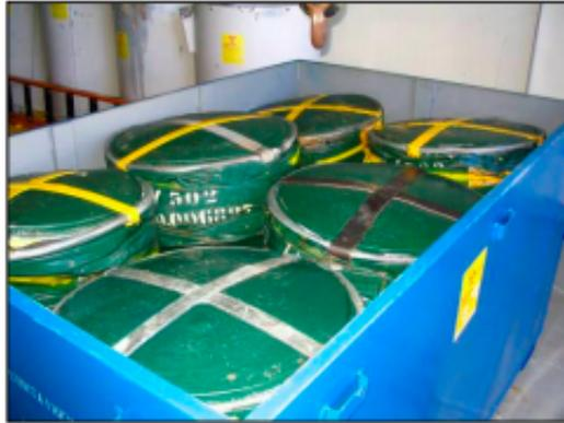
Figura 25 – Caixas que recebem os tambores após compressão e redução de volume. Fonte: (SANTOS; LIMA, 2007)
