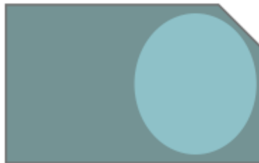
Abbildung 2: Schema eines halbseitig geätzten Prüfkörpers mit Abschrägung oben rechts
