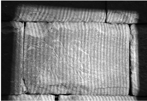
Abb. 11: Projektion von Lichtstreifen auf das ‚Biertrinker‘-Graffito, Wand 204/202N (Foto: C. Kleinitz).
