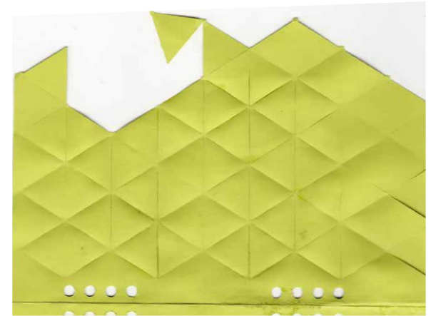
IMATGE 38. Resultat de primer troquel·lar i després encolar amb els papers inicials que a causa del encolat, s'han de canviar (bufat)
