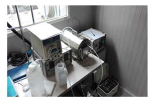
Figure 2. The butanol vaporisation system.
