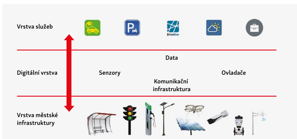
Obrázek 4.1 Třívrstvá architektura chytrého města s digitální vrstvou představující most mezi urbánní infrastrukturou a digitálními službami (zdroj: upraveno dle Sivrikaya et al., 2019)
