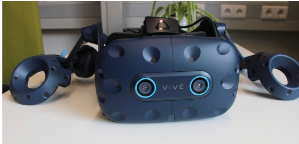
Abb. 1: HTC Vive Pro Eye inklusive Controller als Beispiel für eine PC-gebundene VR-Brille.
