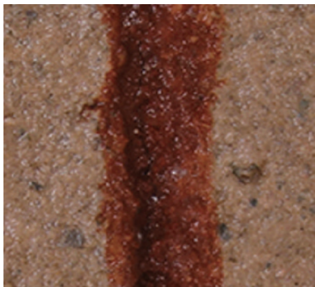
図6 実験1でペルチェモジュールを用いて冷却を行った試験片の実験前の写真 ((a), (b)) と実験直後の写真 ((c), (d))。(e)は(c)を拡大した画像。
