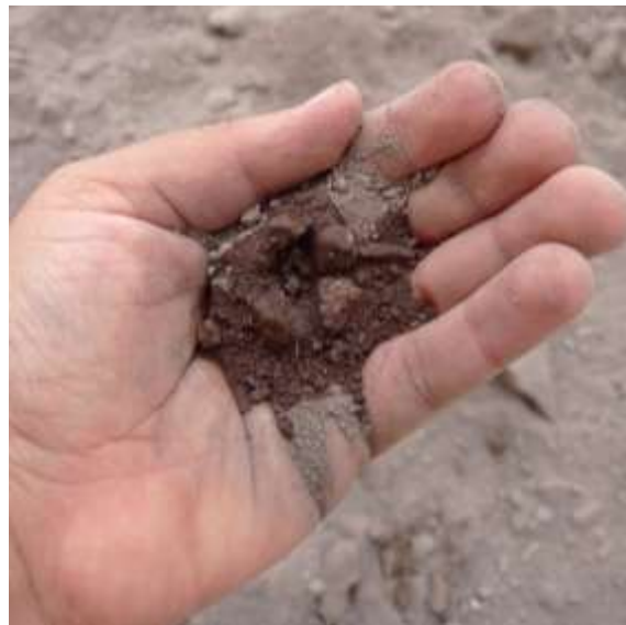
Figura 20: Humedecimiento de la tierra para la prueba de la bolita
