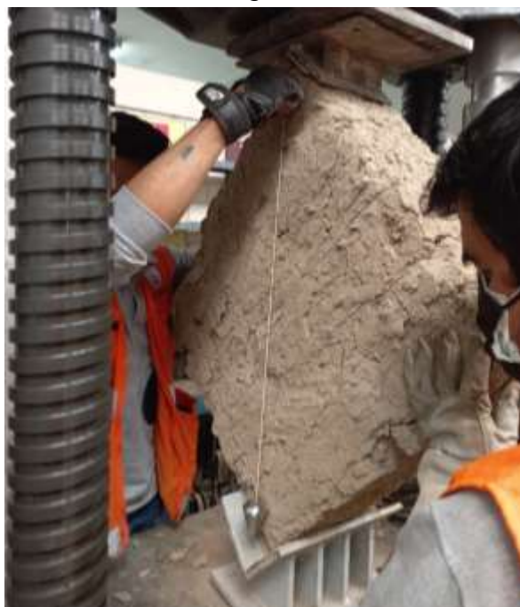
Figura 28: Nivelación del murete patrón durante el ensayo de compresión diagonal
