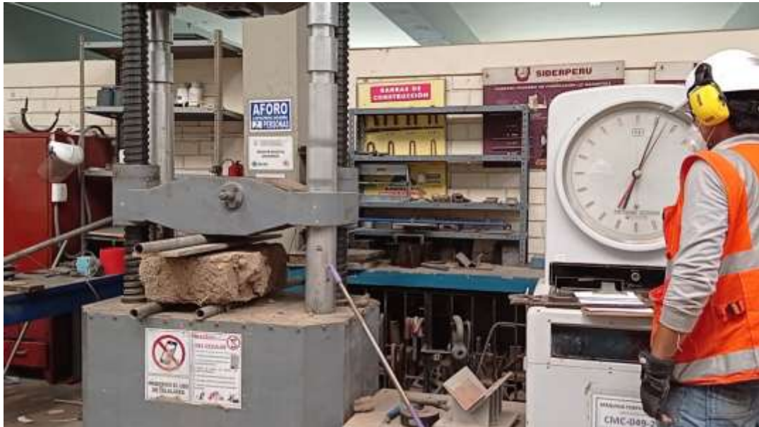
Figura 31: Ensayo de Flexión en murete patrón
