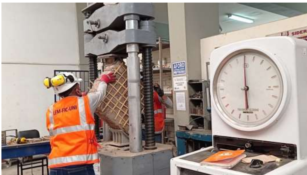
Figura 279: Ensayo de compresión diagonal en murete reforzado a cada 7cm
