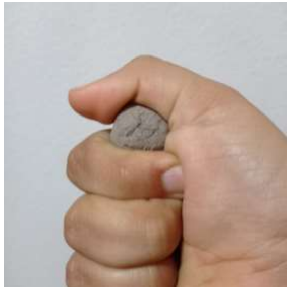
Figura 22: Prueba presencia de arcilla o de la bolita
