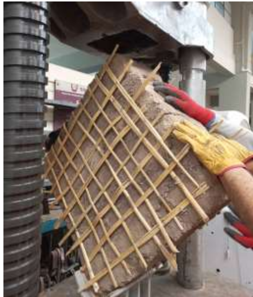
Figura 28: Ensayo de resistencia al Corte en muretes reforzados con malla ecológica a cada 5cm
