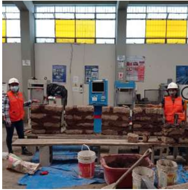
Figura 15: Muretes recién elaborados
