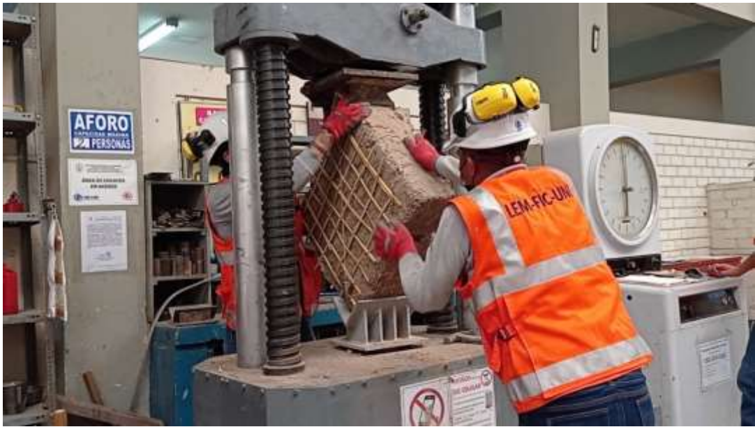
Figura 6: Ensayo de compresión diagonal
