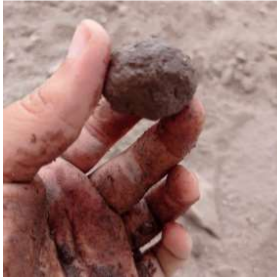
Figura 21: Formación de la bolita
