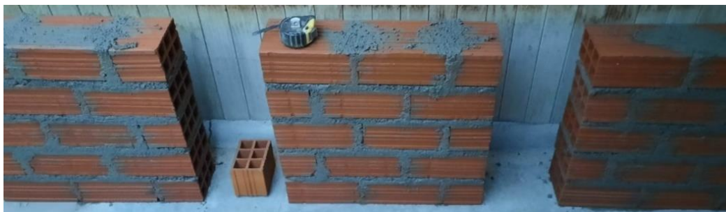
Figura 20. Muretes para ensayo diagonal de albañilería.
