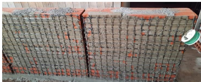
Figura 56. Muretes reforzados con geomalla biaxial.
