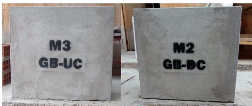
Figura 7. Muretes reforzados con geomalla biaxial.
