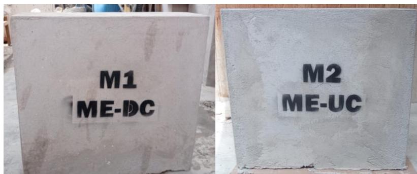
Figura 4. Muretes reforzados con malla electrosoldada.
