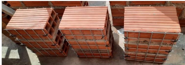
Figura 3. Pilas reforzadas con malla electrosoldada.
