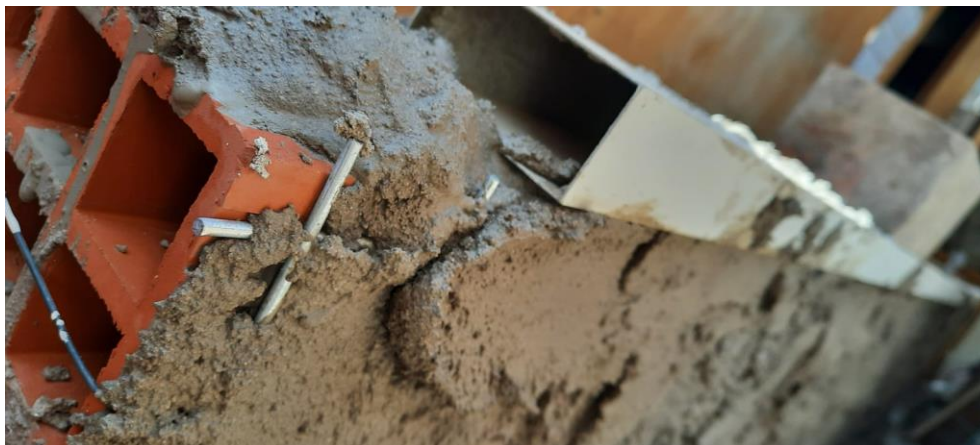
Figura 82. Muretes reforzados con malla electrosoldada.
