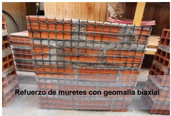
Elaboración de pilas para ensayo de albañilería
