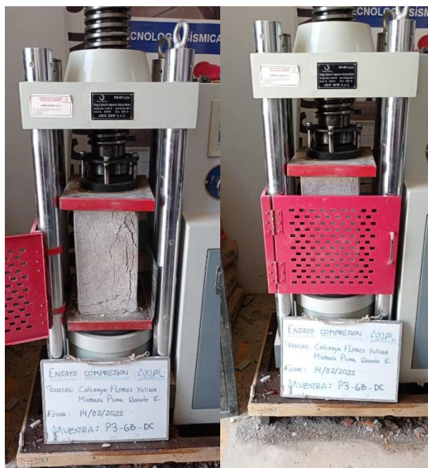
Figura 23. Ensayo de compresión axial.
