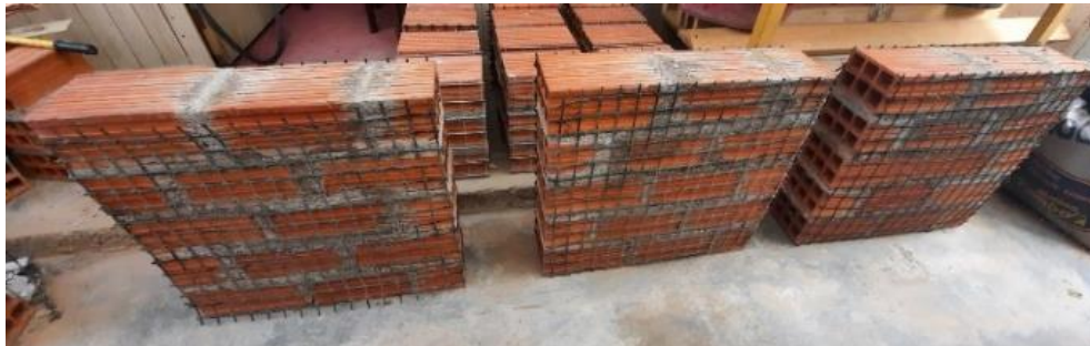
Figura 5. Aplicación de geomalla biaxial al murete.
