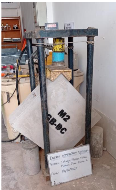
Figura 22. Ensayo de compresión diagonal.
