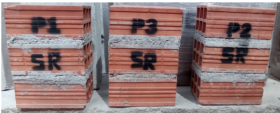
Figura 21. Pilas para el ensayo compresión axial de albañilería.
