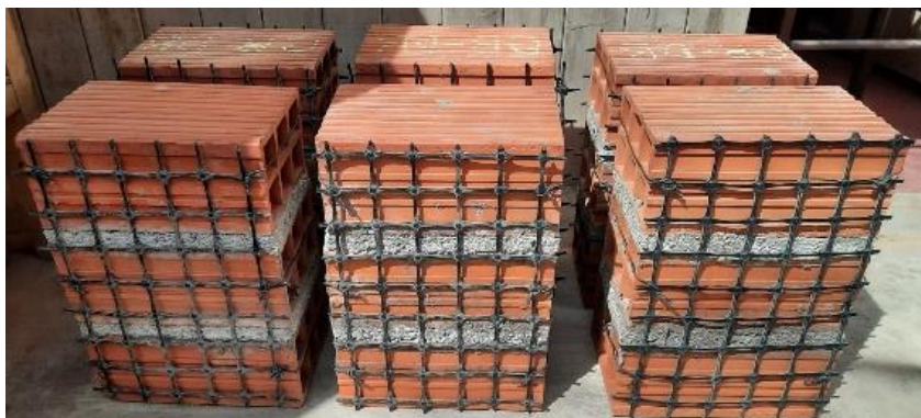
Figura 8. Pilas reforzadas con malla electrosoldada.
