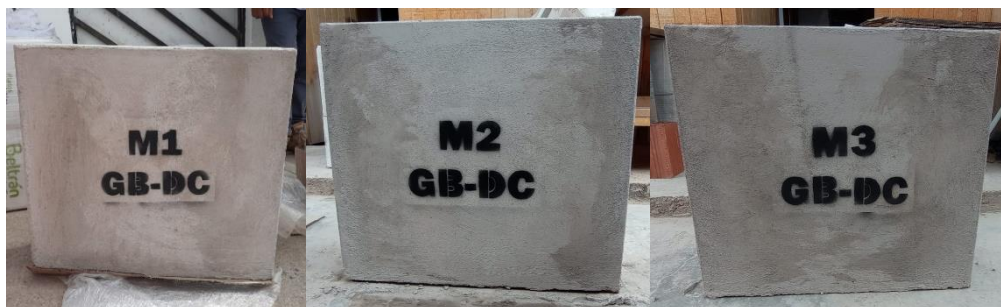
Figura 56. Muretes reforzados con geomalla biaxial.
