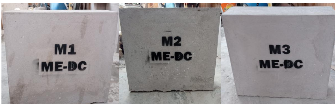
Figura 82. Muretes reforzados con malla electrosoldada.
