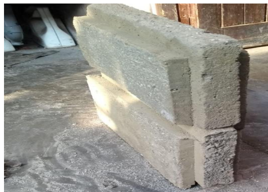
Figura 1. Bloque apilable de (0.09x0.25x0.50)
