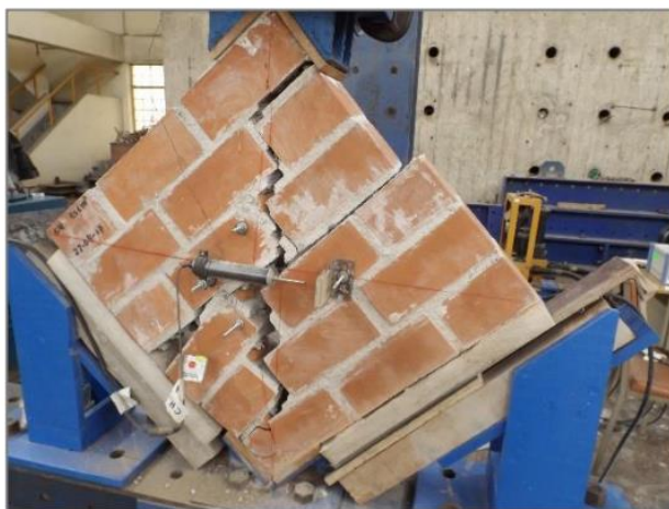
Figura 40: Falla del murete
