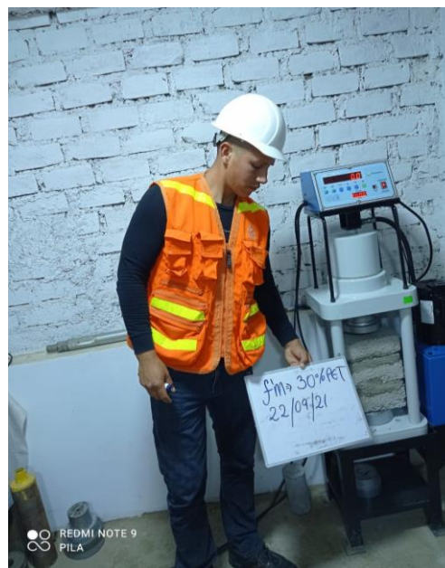
Figura 33: Ensayo f'm 0%PET
