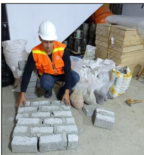
Falla por corte
