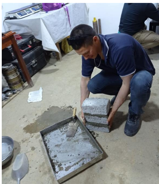
Figura 32: Construcción de pilas
