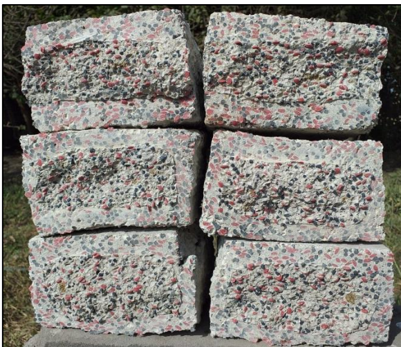
Sección transversal de ladrillos (30%PET)
