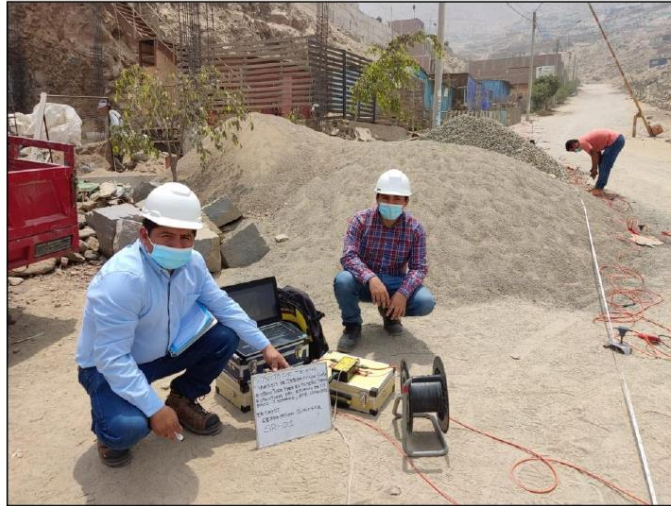
Foto 01: Tendido de línea de refracción sísmica 01.
