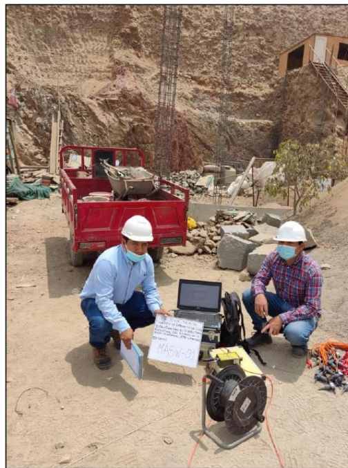
Foto 02: Adquisición de datos de MASW-01
