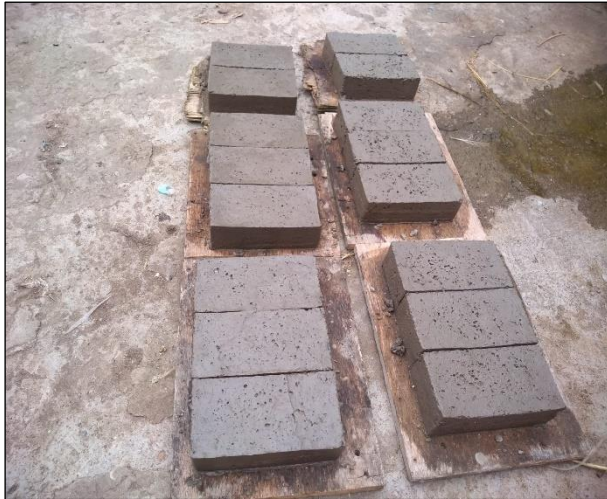
Fotografía 05: Adoquín de concreto en su estado fresco y moldeado
