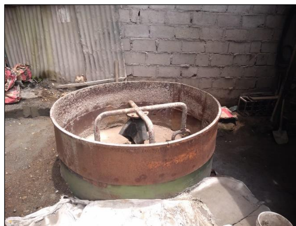
Fotografía 04: Mezcladora de concreto para la elaboración del adoquín de concreto
