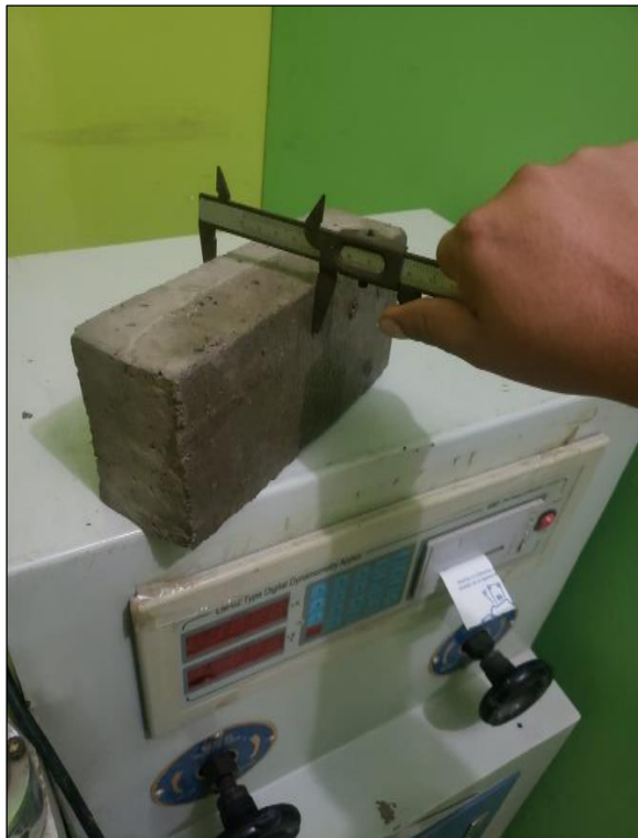
Fotografía 07: Determinación de la variación dimensional con vernier calibrado
