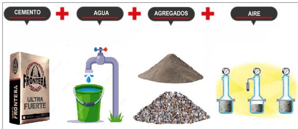
Figura 5. Componentes del adoquin de concreto
