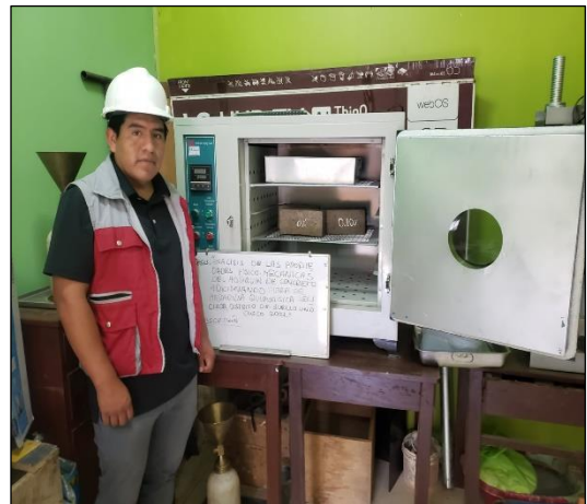
Fotografía 12: Colocado del adoquín al horno durante 24 horas a T° de 105 °C
