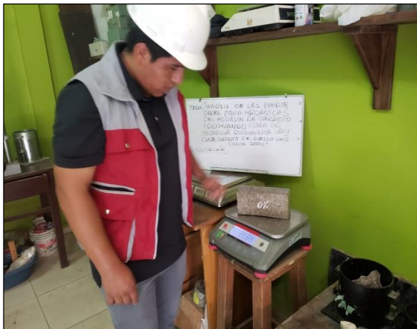
Fotografía 11: Pesado del adoquín sumergido después de 24 horas
