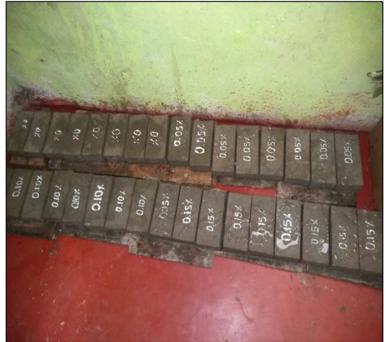
Fotografía 06: Adoquín de concreto en su estado duro e identificado con las dosificaciones
