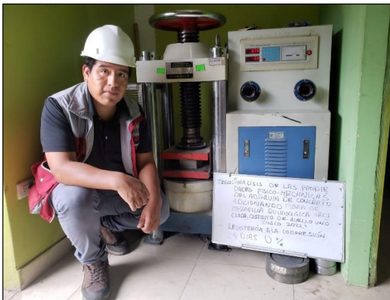
Fotografía 15: Ensayo de resistencia a la compresión a la edad de 28 días
