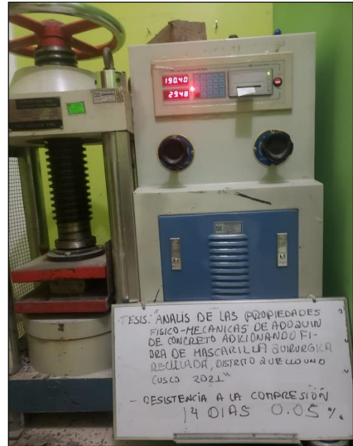
Fotografía 14: Ensayo de resistencia a la compresión a la edad de 14 días
