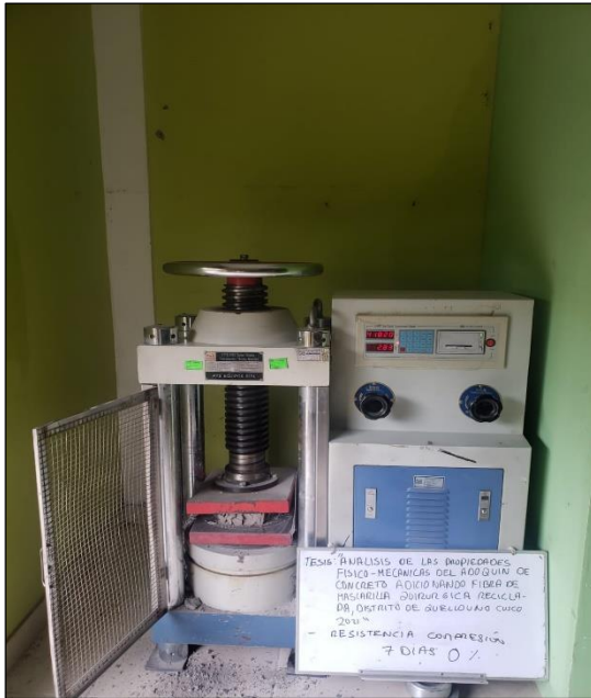
Fotografía 13: Ensayo de resistencia a la compresión a la edad de 07 días
