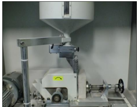
Fotografía 16: Ensayo de resistencia a la abrasión
