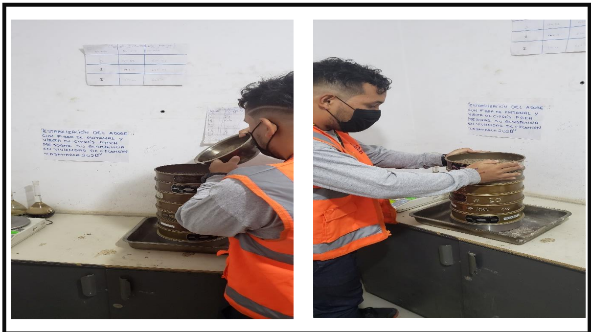
Figura 4. Tamizado de la muestra pasante por las mallas.
