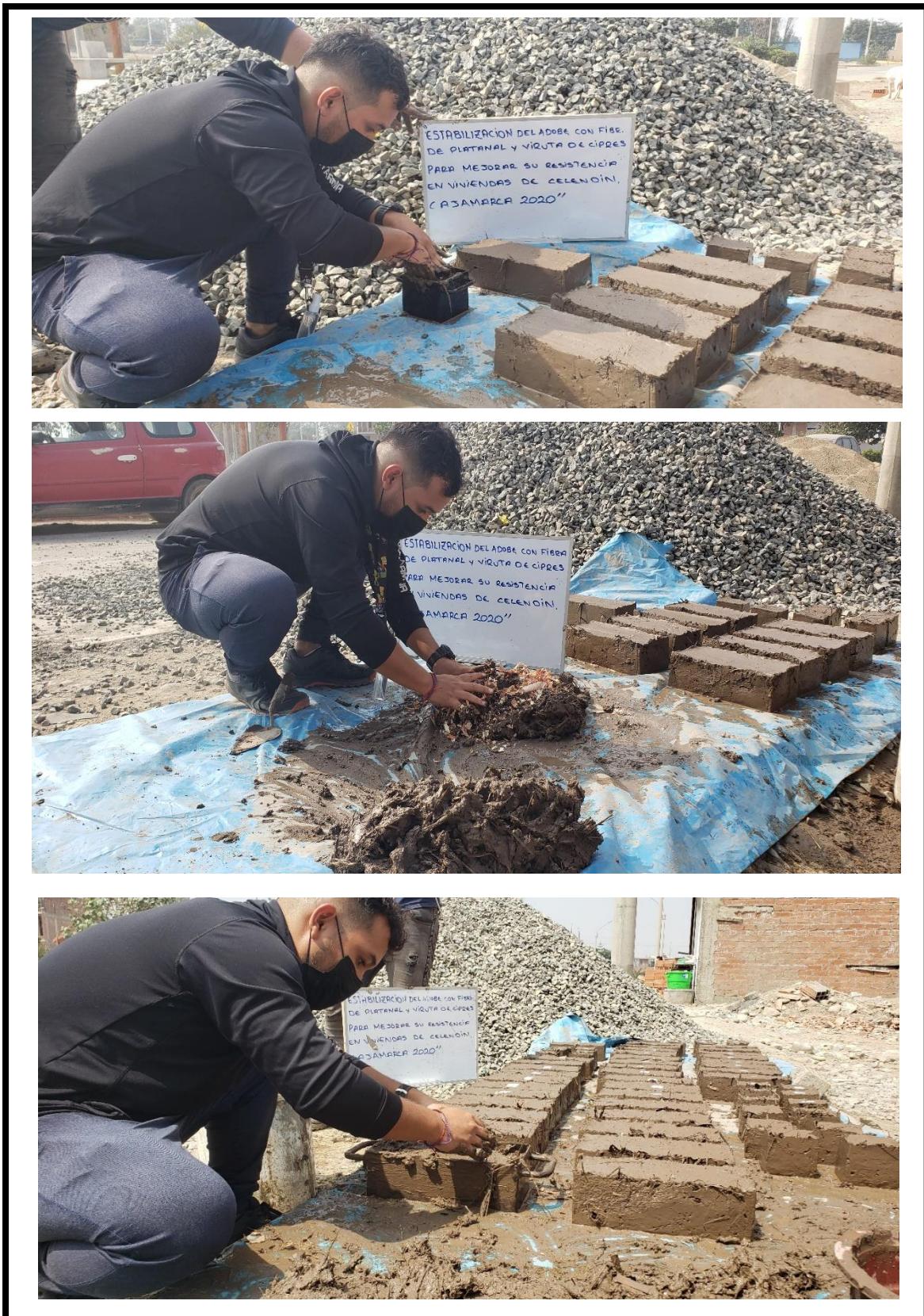
Figura 16. Fabricación del adobe para resistencia a compresión, flexión y absorción.
