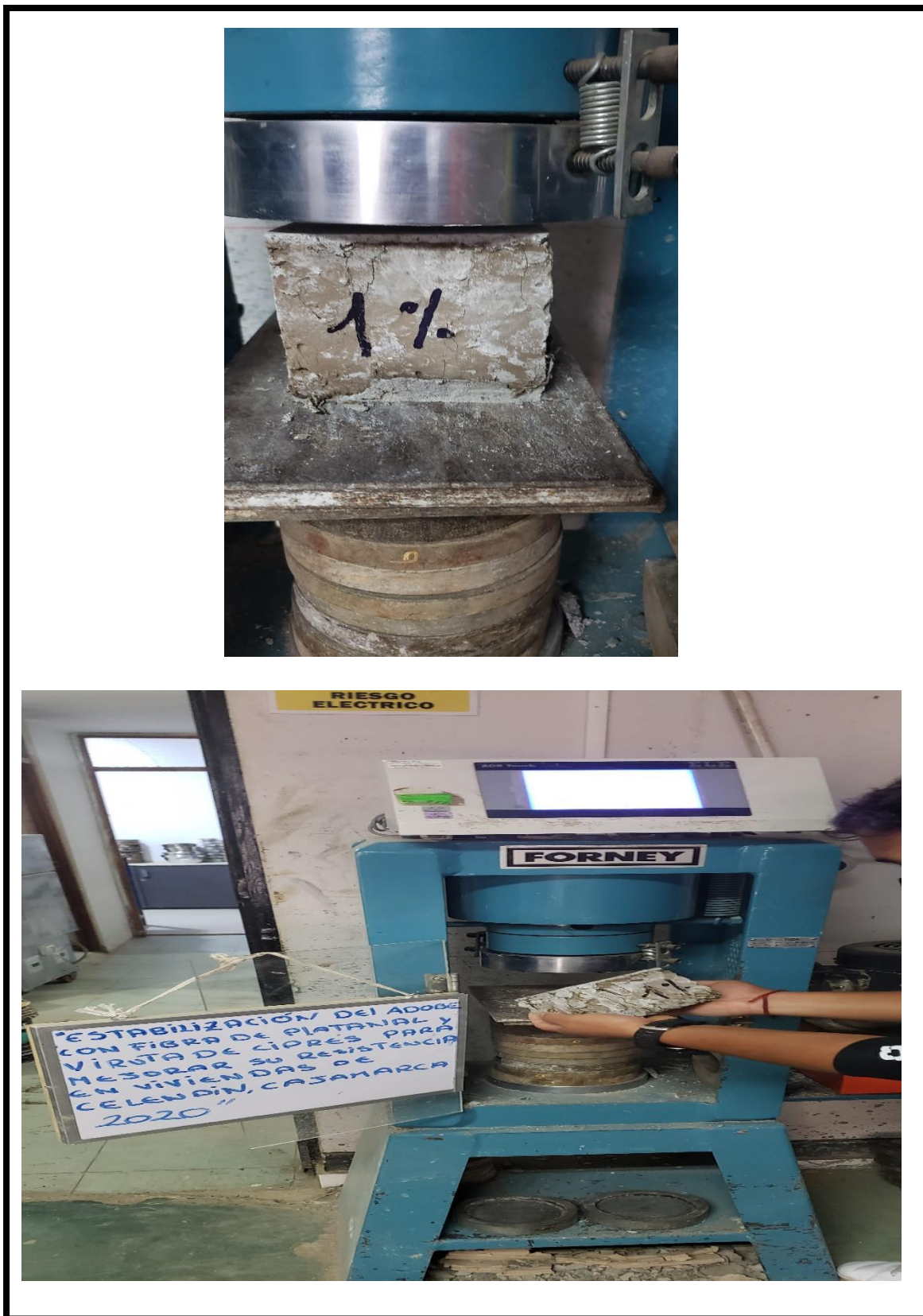
Figura 21. Ensayo a compresión de la muestra al 1% de fibra en el adobe.
