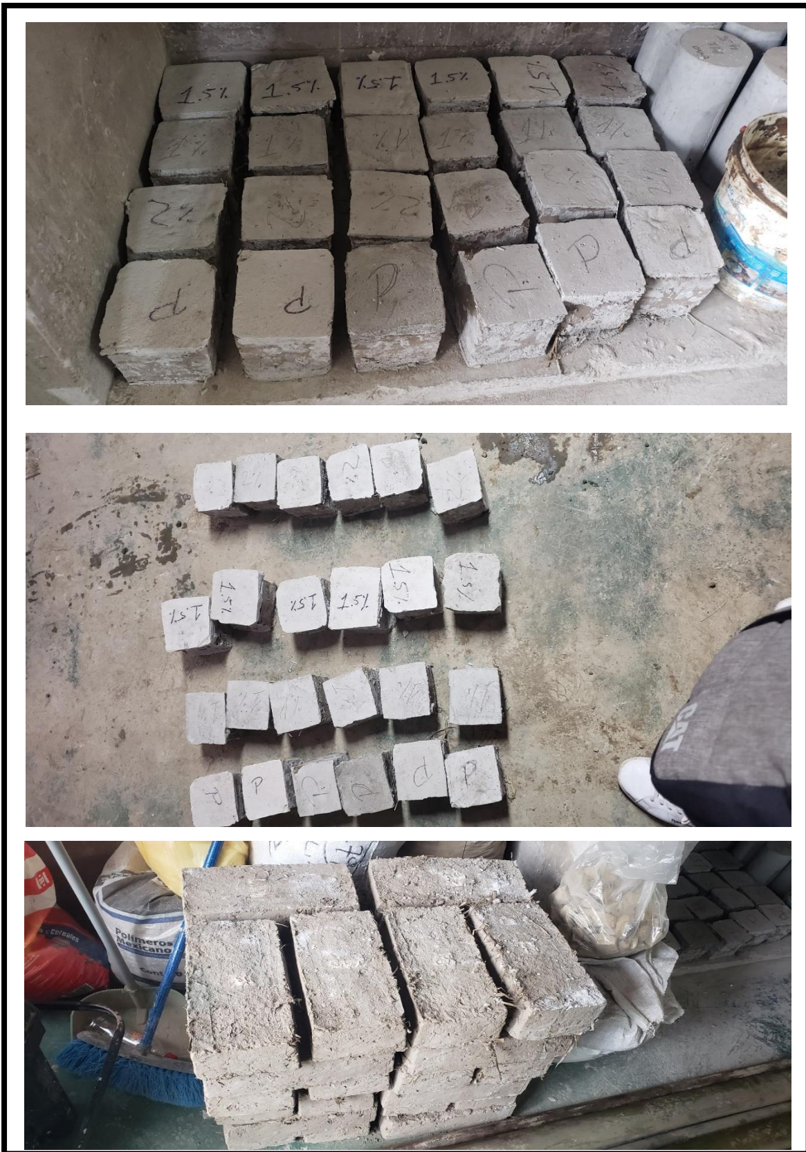
Figura 18. Muestras capeadas y secas para sus respectivos ensayos.
