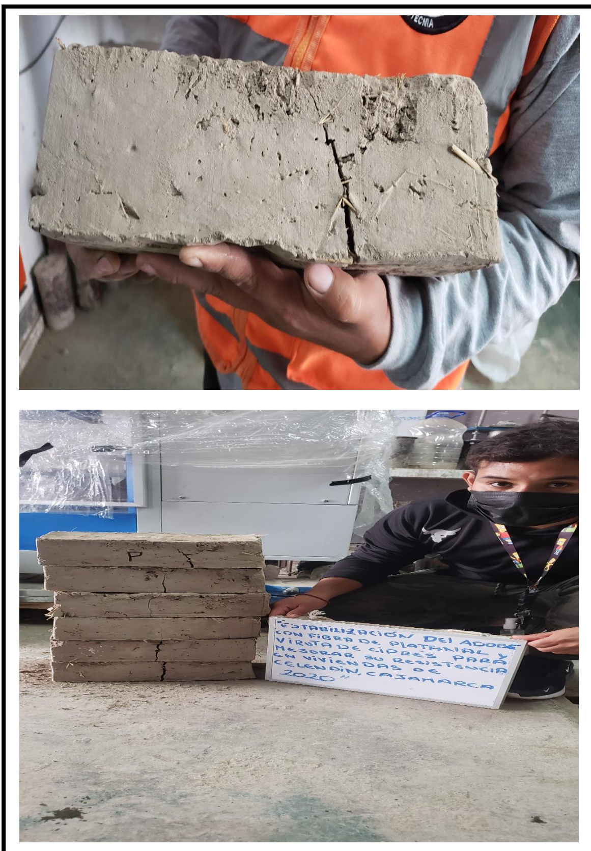
Figura 29. Resumen de muestras ensayadas a flexión.
