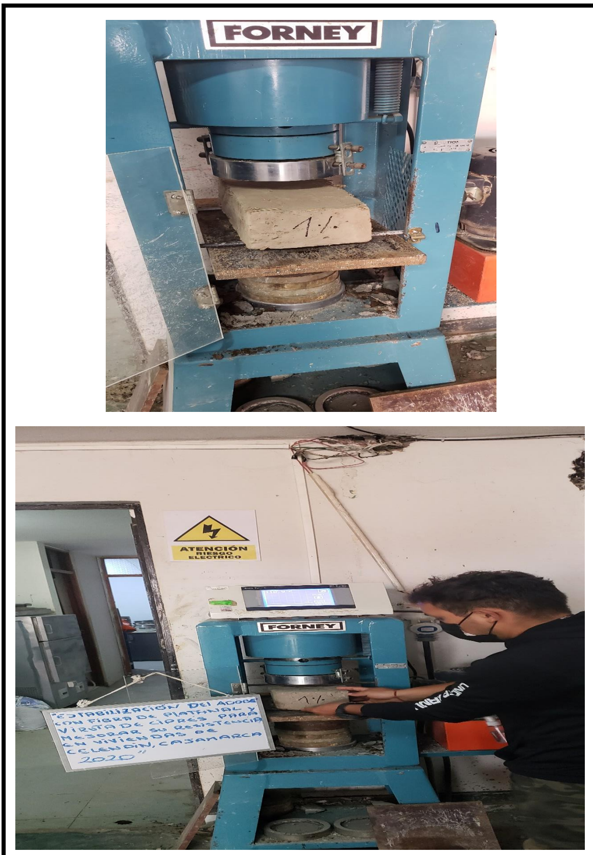
Figura 30. Ensayo a flexión de la muestra al 1.0% de fibra en el adobe.
