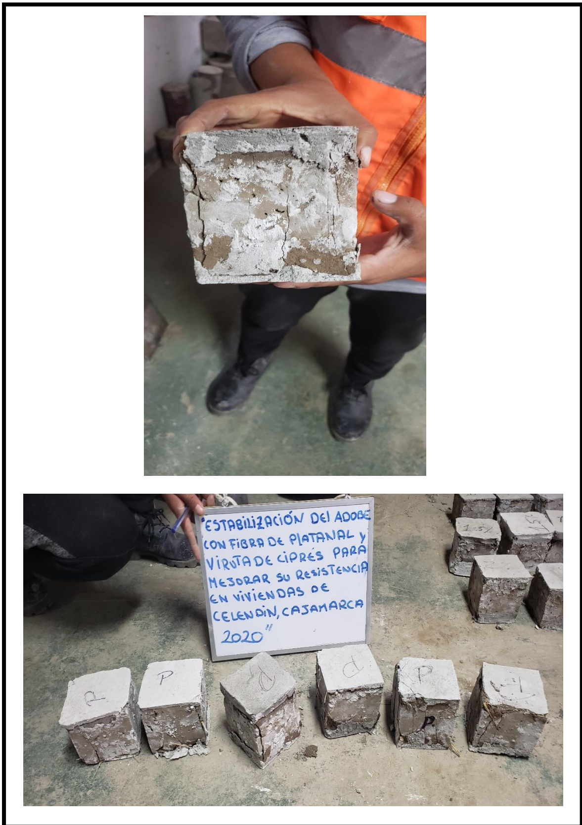
Figura 20. Resumen de muestras ensayadas a compresión.
