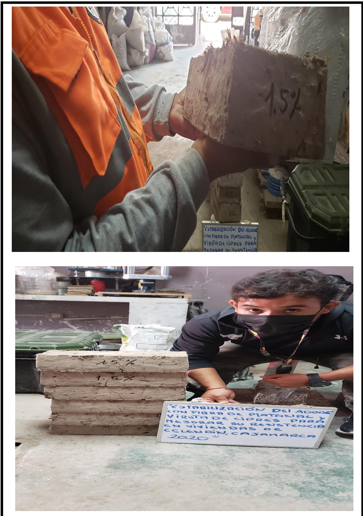
Figura 33. Resumen de muestras ensayadas a flexión.
