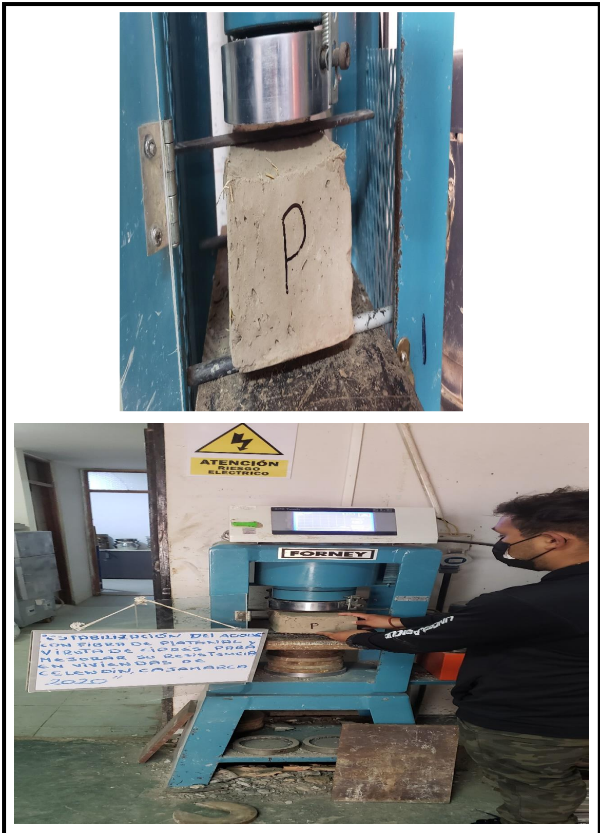
Figura 28. Ensayo a flexión de la muestra patrón del adobe.
