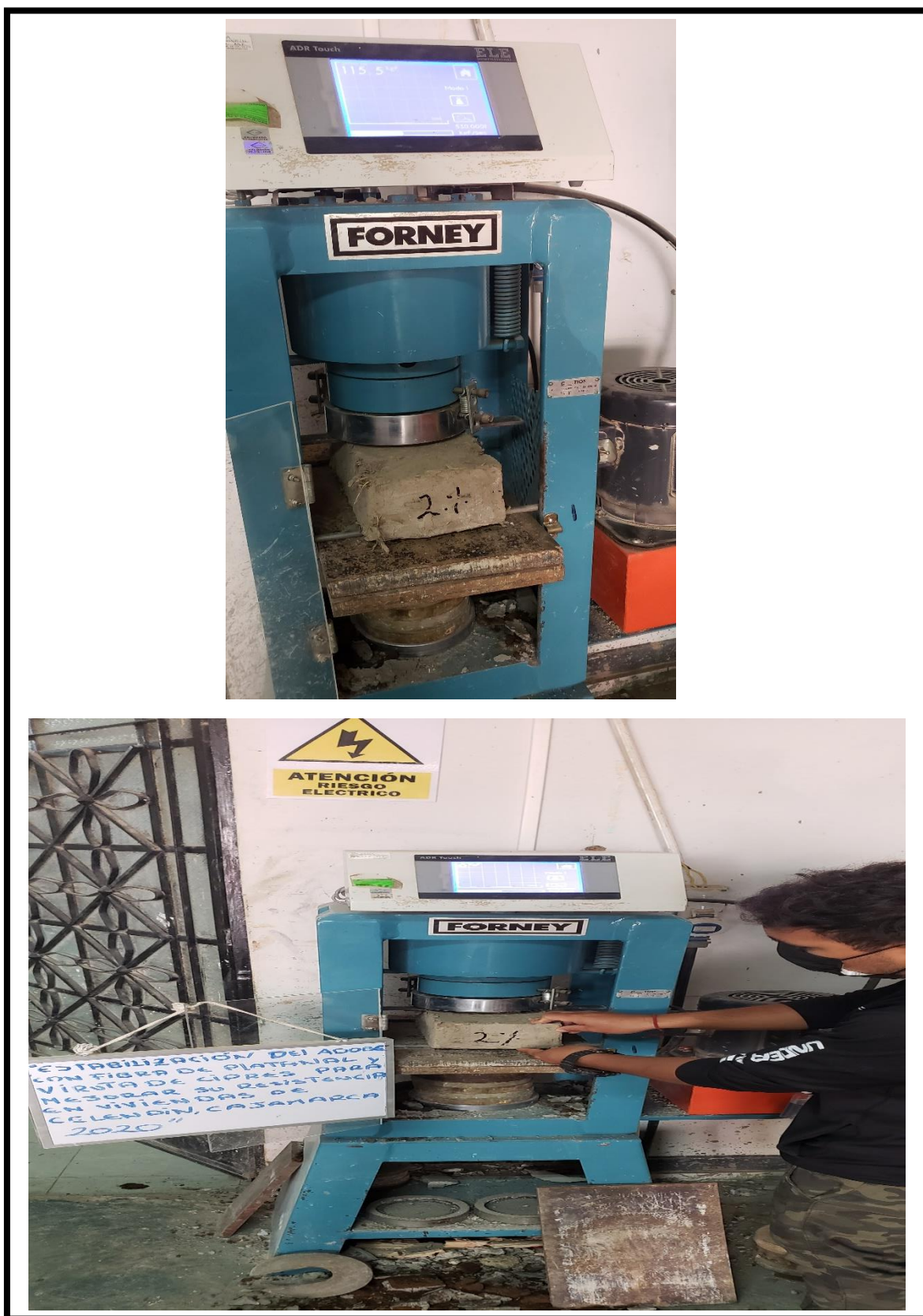
Figura 34. Ensayo a flexión de la muestra al 2.0% de fibra en el adobe.
