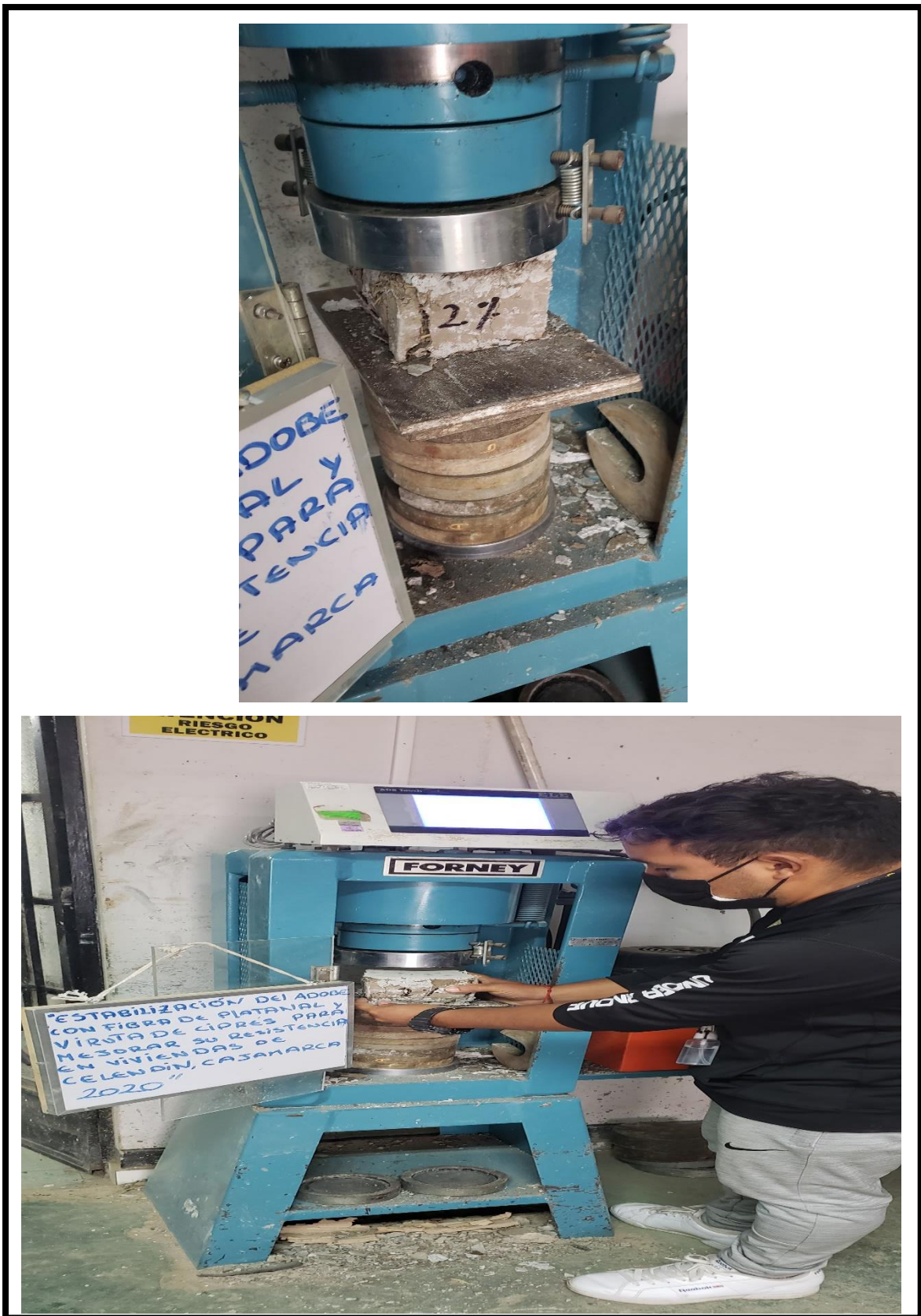
Figura 25. Ensayo a compresión de la muestra al 2.0% de fibra en el adobe.
