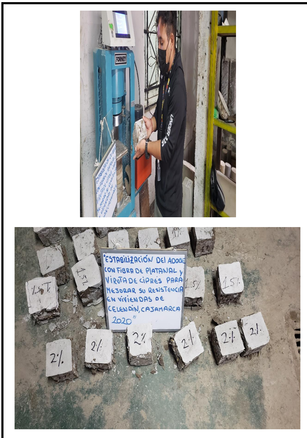
Figura 26. Resumen de muestras ensayadas a compresión.
