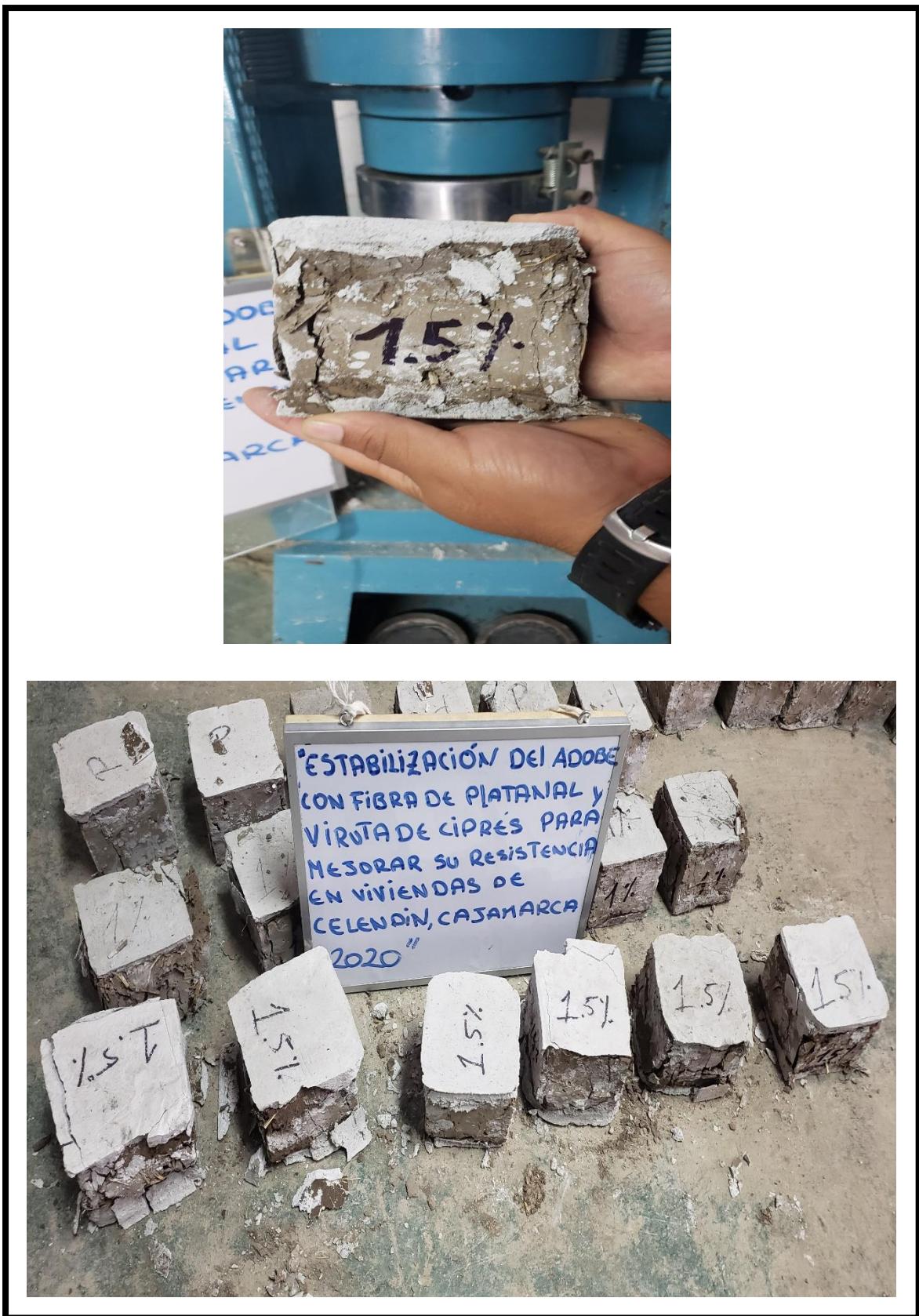
Figura 24. Resumen de muestras ensayadas a compresión.
