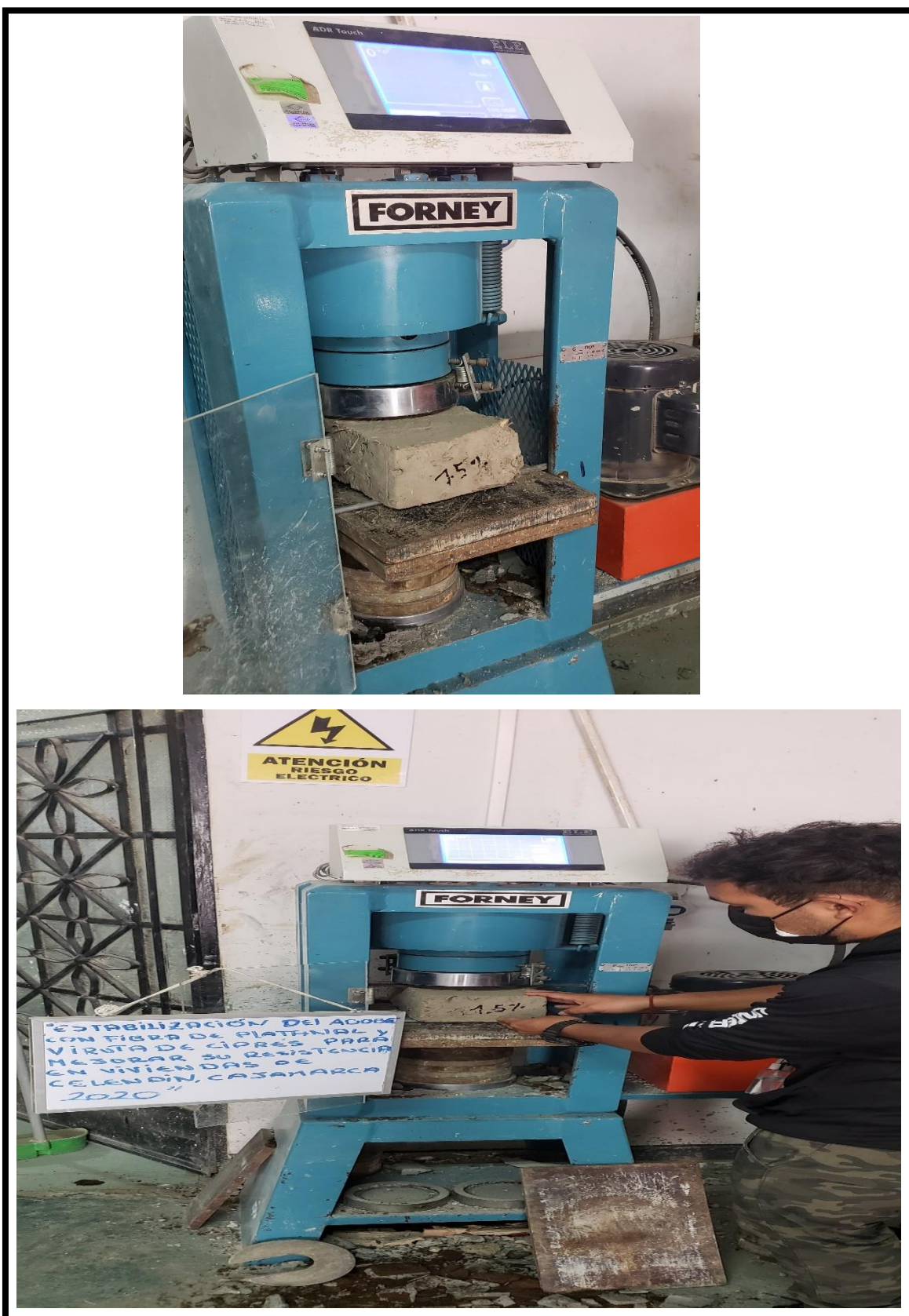
Figura 32. Ensayo a flexión de la muestra al 1.5% de fibra en el adobe.
