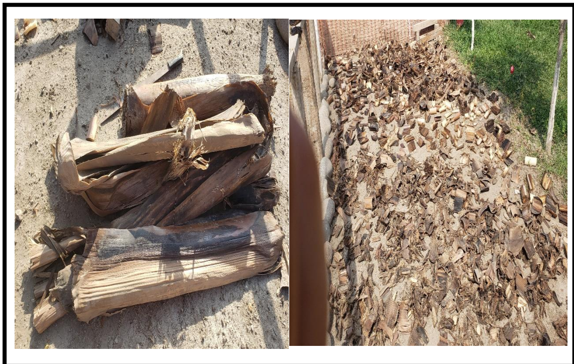
Figura 11. Secado de la fibra de platanal y cortado.
