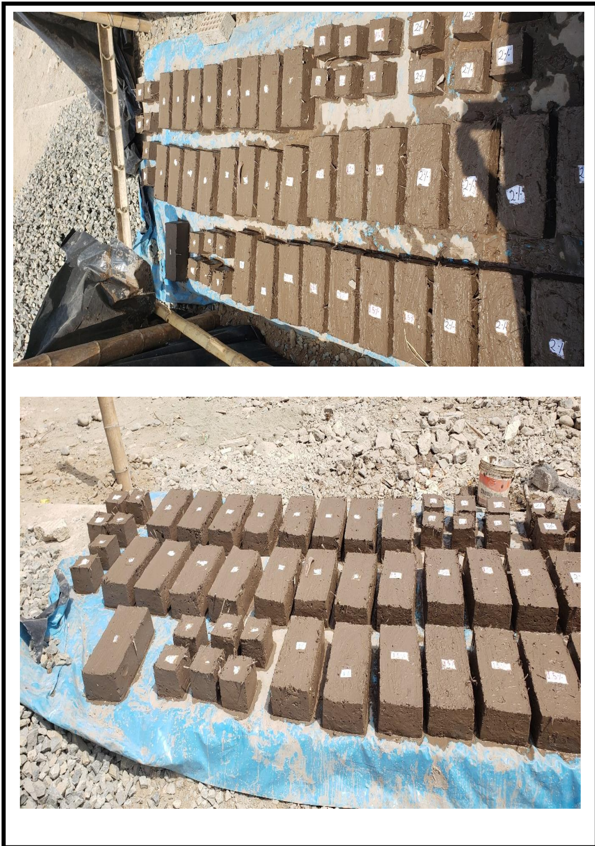
Figura 17. Secado de las muestras de adobe para los ensayos correspondientes.
