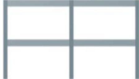
Este sistema estructural (Aporticado), tiene grandes ventajas como permitir ejecutar todas las modificaciones que se quieran al interior, y que los muros, al no soportar cargas tienen la posibilidad de moverse, permitiendo implementar divisiones flexibles en el equipamiento.
