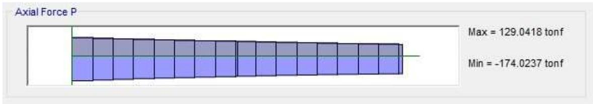
**Figura 46.** Demanda de axial sobre el elemento de borde en el extremo izquierdo
