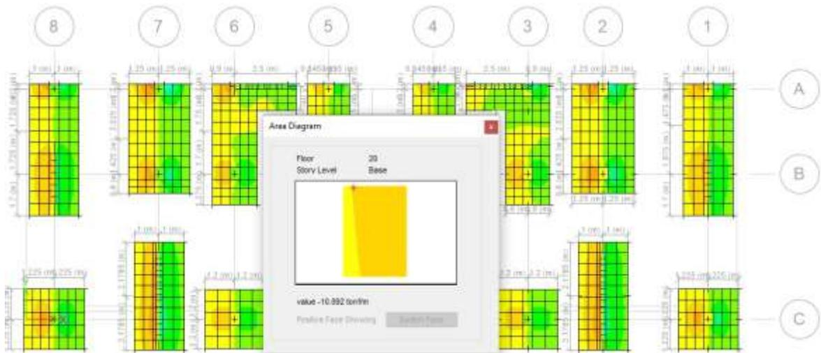
**Figura 53.** Diagrama de fuerzas cortantes V13(+) en dirección XX
