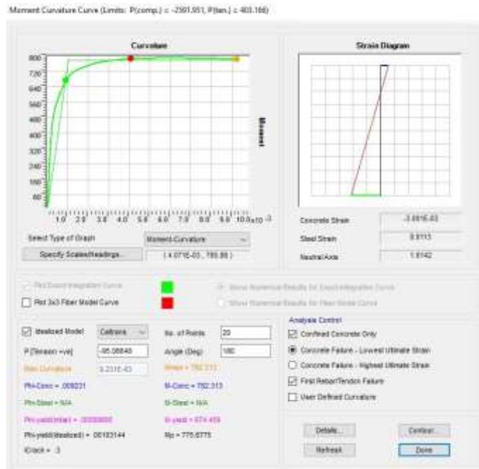
**Figura 44.** Deformación del acero en el extremo a tracción cuando  $\epsilon_c=3/1000$  (SYMÍN)
