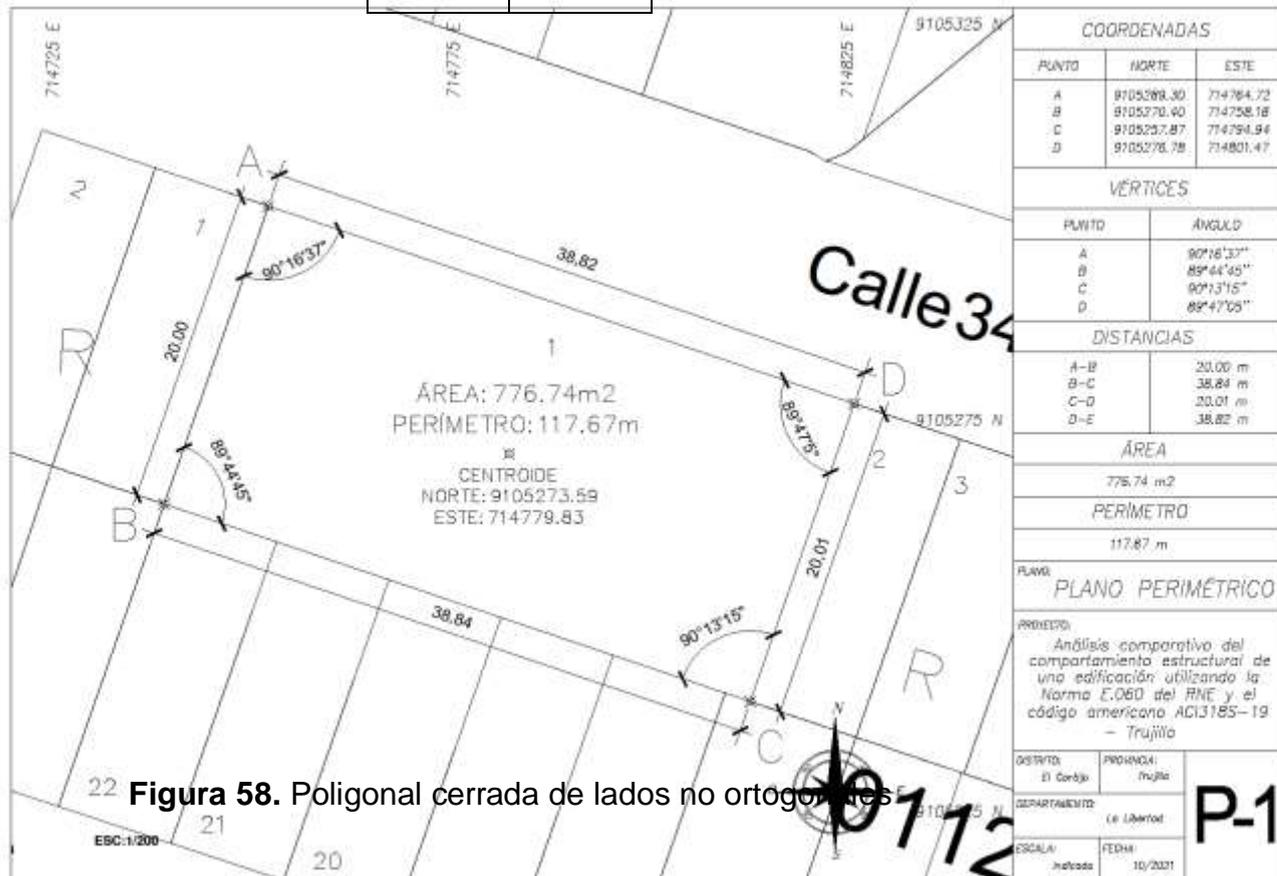
**Figura 58.** Poligonal cerrada de lados no ortogonales
