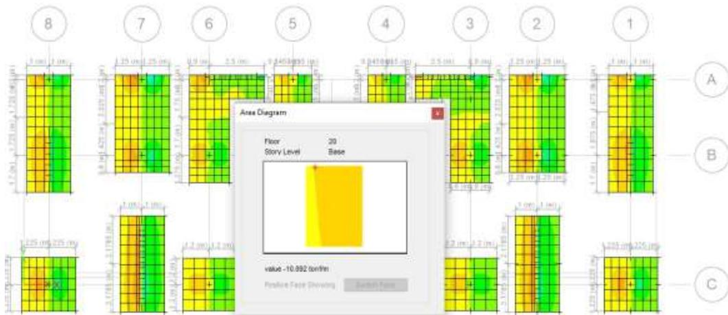
**Figura 56.** Diagrama de fuerzas cortantes V13(+) en dirección XX
