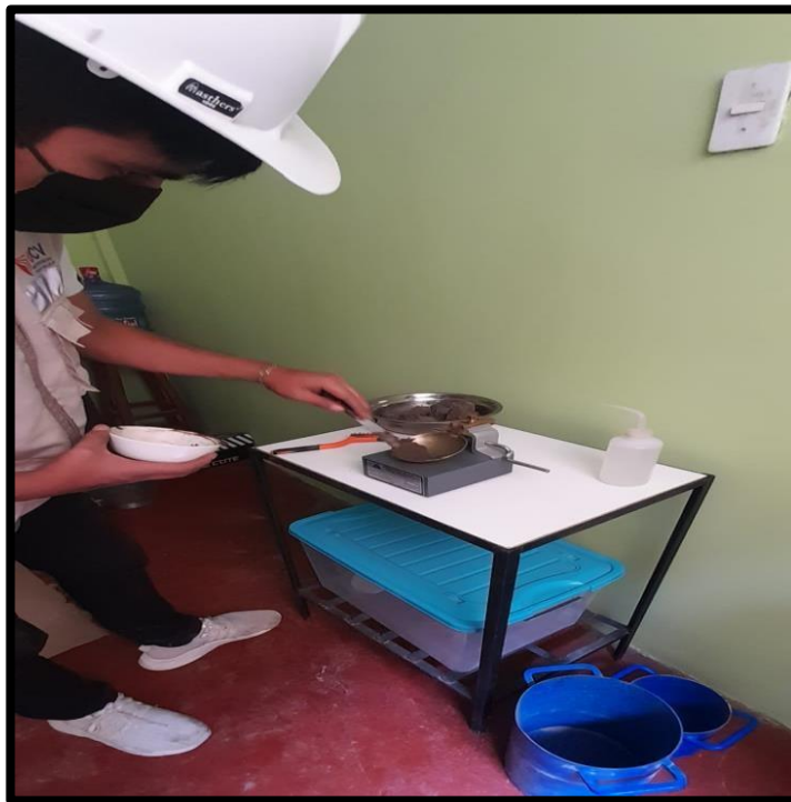
FOTO N° 08: ENSAYO DE COPA CASAGRANDE
