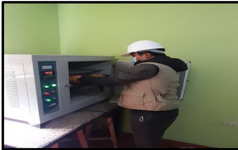
FOTO N° 04: RETIRANDO EL MATERIAL DEL HORNO
