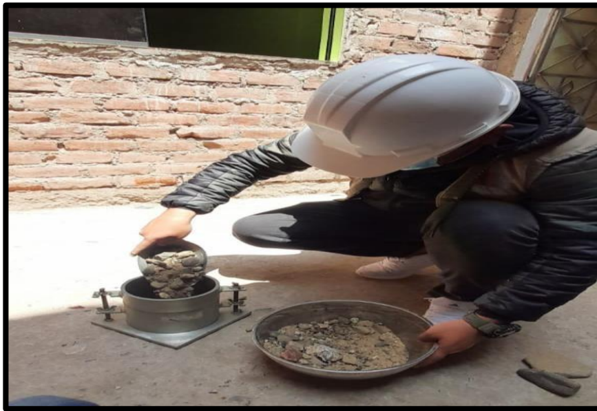
FOTO N° 05: COLOCACION DEL MATERIAL PARA PROCTOR
