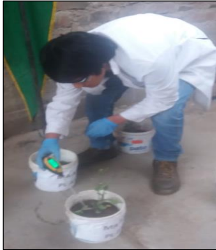
Figura 32. Monitoreo in-situ de parametros de pH, humedad y temperatura
