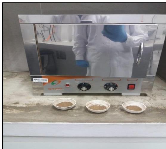
Figura 35. Secado en la mufla las muestras de suelo a analizar
