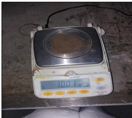
Figura 34. Peso de la muestra exacta del suelo en la báscula y balanza analítica
