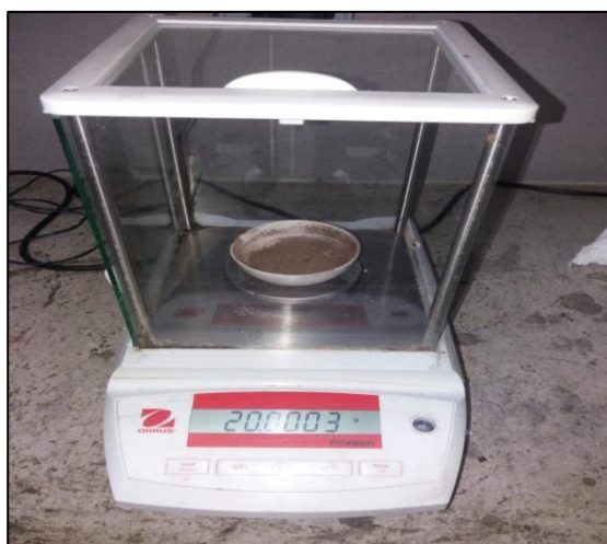
Figura 34. Peso de la muestra exacta del suelo en la báscula y balanza analítica
