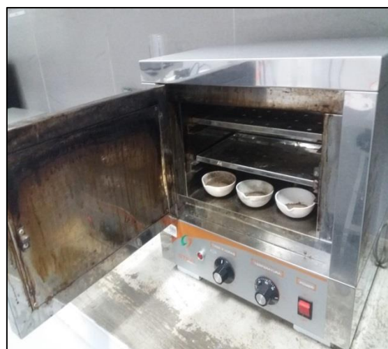
Figura 35. Secado en la mufla las muestras de suelo a analizar
