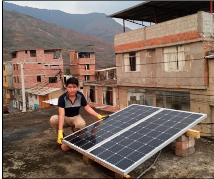
Pruebas realizadas del rendimiento de los módulos fotovoltaicos en 10°grados de inclinación respecto a la horizontal.
