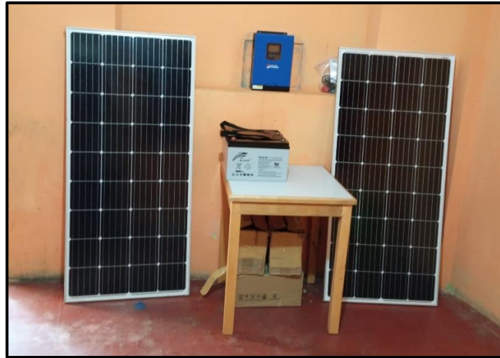
Componentes del sistema fotovoltaico lista para ser instalados
