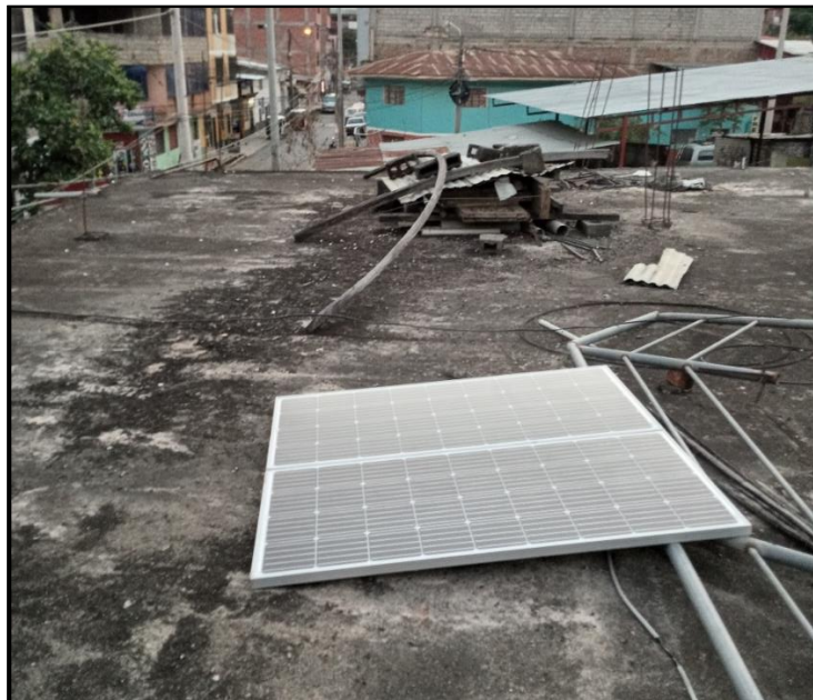
Pruebas realizadas del rendimiento de módulos fotovoltaicos en 0^{\circ} grados de inclinación respecto a la horizontal.
