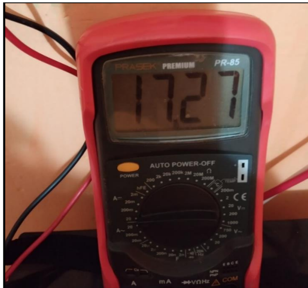
Medición de la intensidad de corriente eléctrica del panel solar en hora punta.
