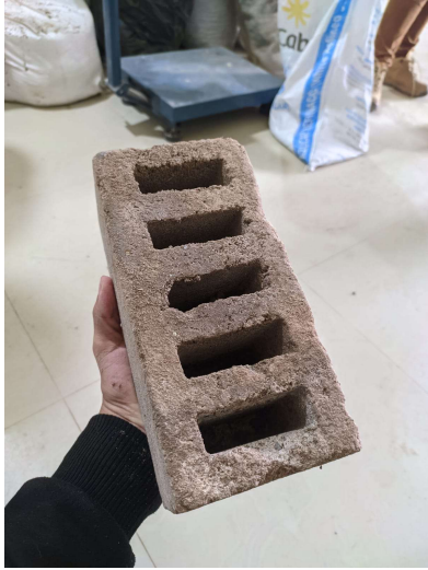
Fotografía N°29: Evidencia de la elaboración de ladrillo tipo P terminado.
