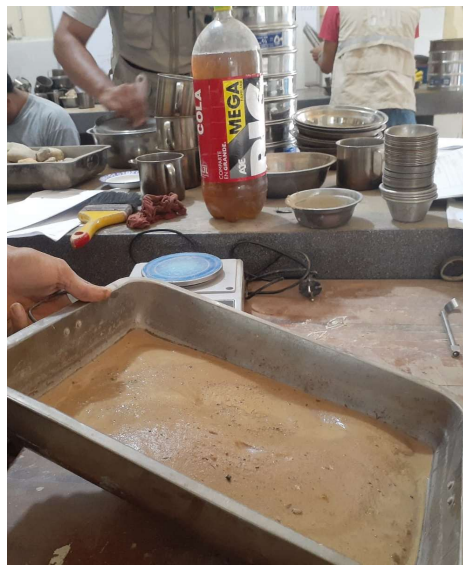
Fotografía N°19: Evidencia del lavado de la muestra para el ensayo de granulometría
