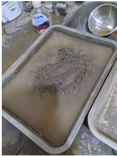
Fotografía N°13 Evidencia del lavado de la muestra para el ensayo de granulometría
