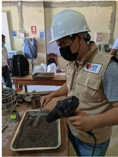
Fotografía N°17. Evidencia del secado de la muestra para el ensayo.
