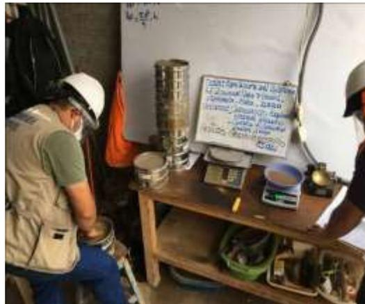
**DESCRIPCIÓN:** Se puede apreciar la realización de la granulometría que permite conocer la medida de los granos de los sedimentos. Mediante el análisis granulométrico se puede obtener información importante como: su origen, propiedades mecánicas y el cálculo de la abundancia de cada uno de los granos según su tamaño dentro de la escala granulométrica.
