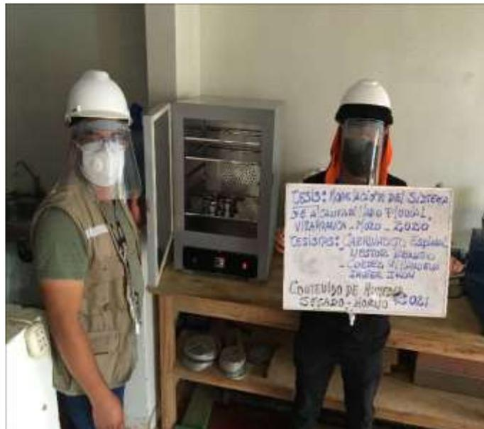
DESCRIPCIÓN: Se puede observar que se realiza el cálculo del contenido de humedad del suelo restando el peso del suelo seco por el peso del suelo húmedo, y luego dividiendo por el peso del suelo seco. Aunque la medida es simple, es importante determinar el contenido de humedad del suelo con el fin de comprender mejor las características del suelo.
