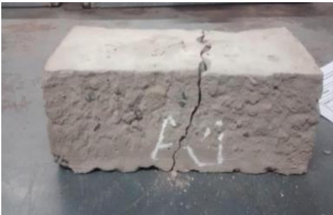
Foto N°08 Viga flexionada de concreto después de usarlo en la Maquina de Flexión
