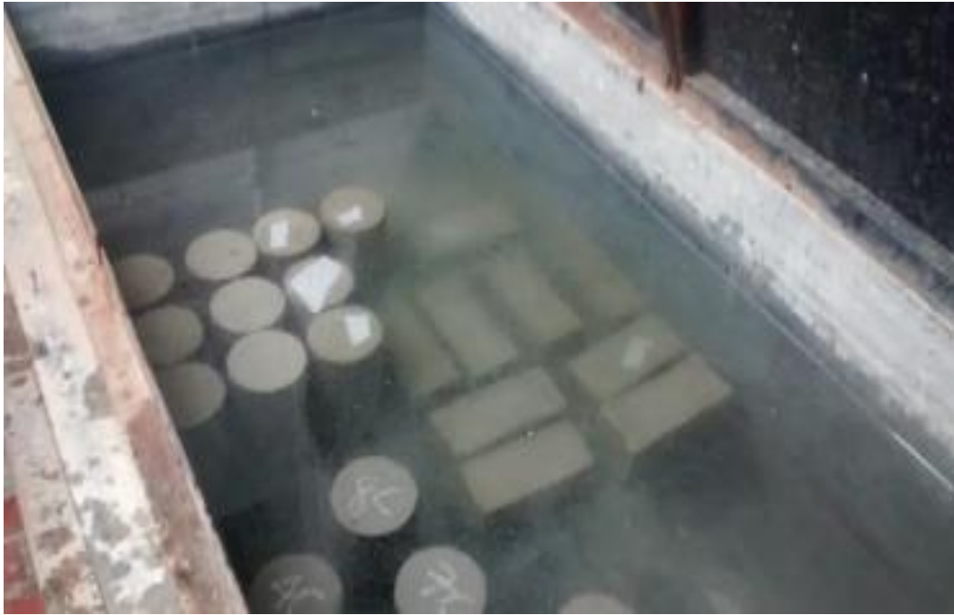
Foto N°03 Curado de Testigo para los 28 días
