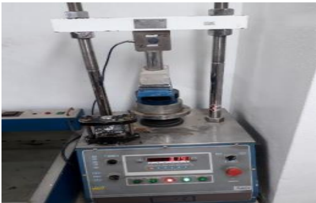
Foto N°06 Ensayo de Flexión con Probeta de viga
