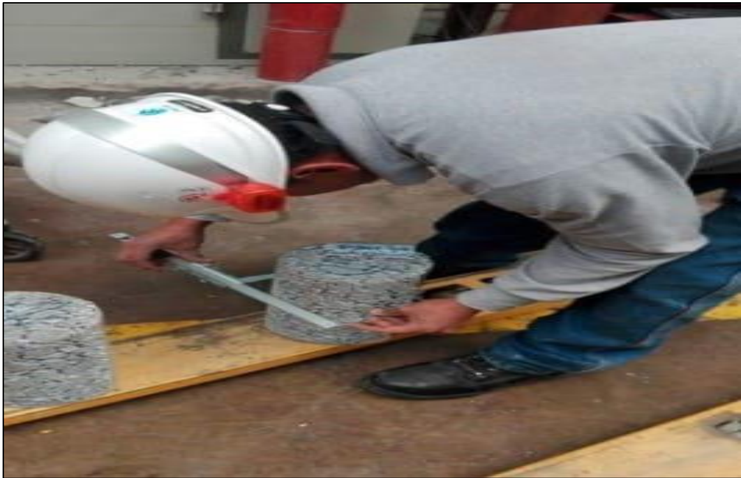
Foto N°05 Midiendo los Testigos antes de hacer los ensayos.
