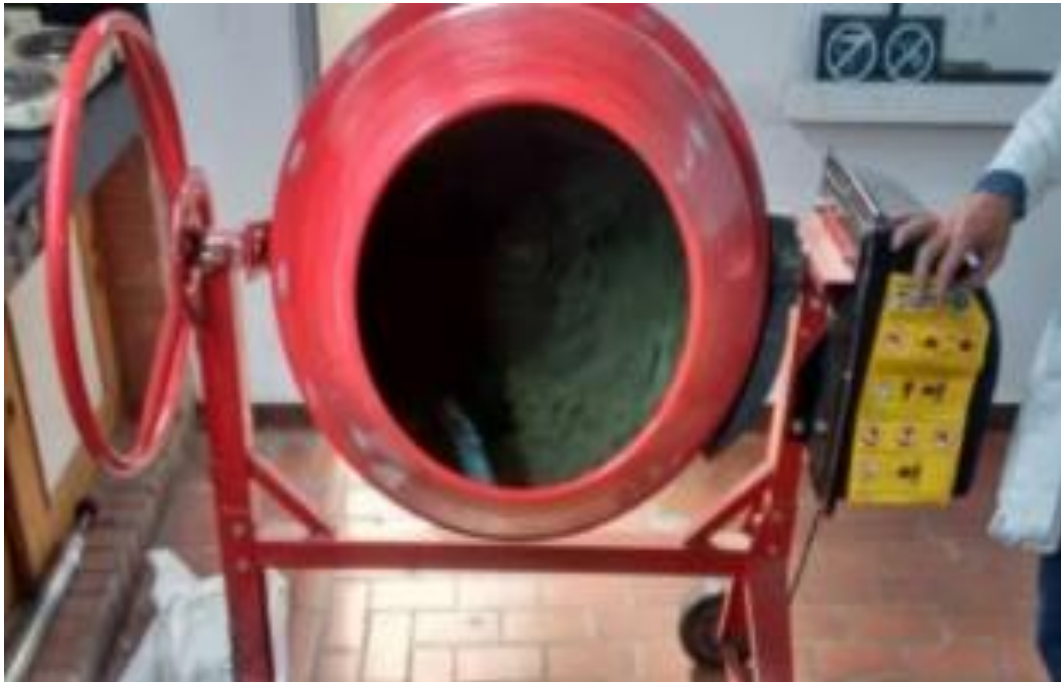
Foto N°01 Trompo mezclador donde se pusieron las dosificaciones de A/C para los Testigos de Concreto Permeable
