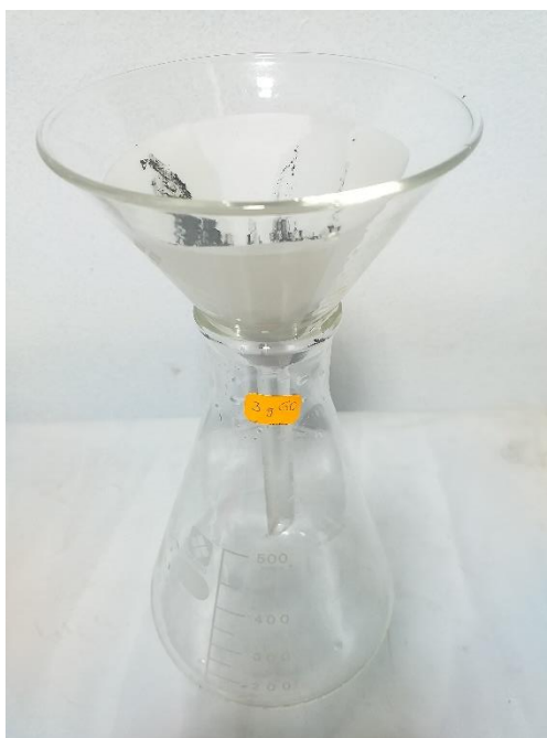
Figura 12. Tratamiento del lixiviado con el nanofiltro 1
