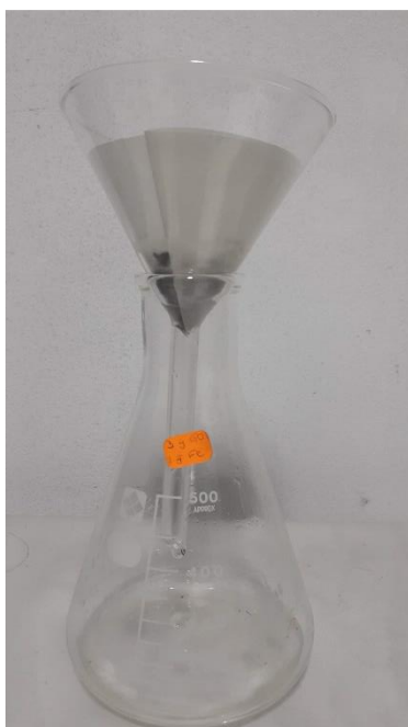
Figura 16. Tratamiento del lixiviado con el nanofiltro 5
